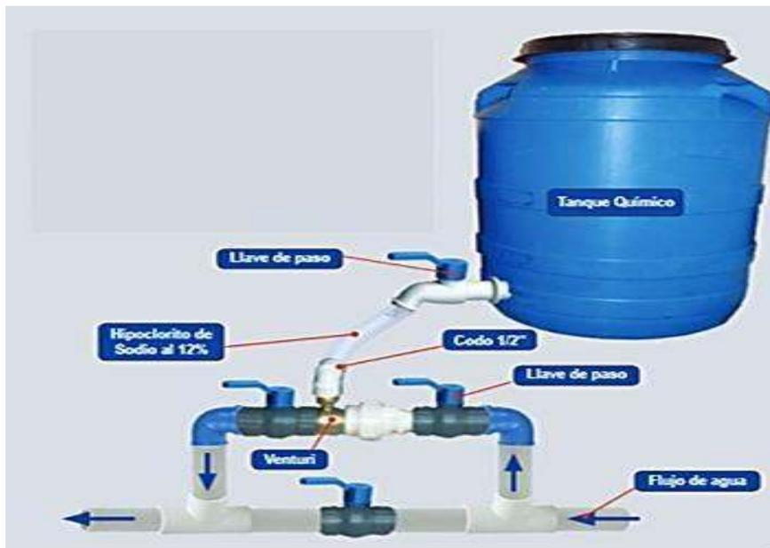
*Figura 6. Hipoclorador hidráulico por Venturi*
