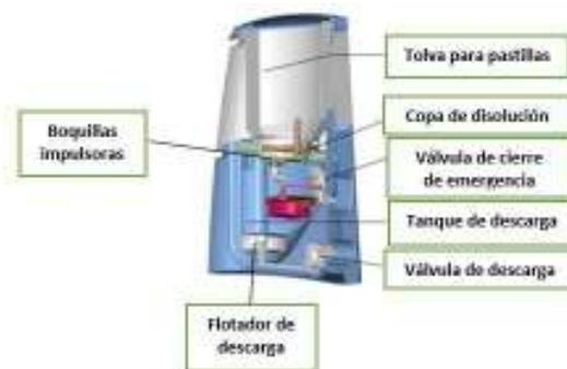
**Figura 15.** Partes principales del clorador Pulsar 1
