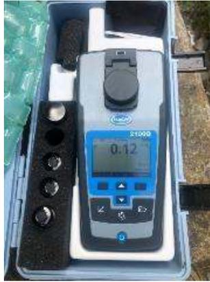
**Figura 22.** Turbidímetro
