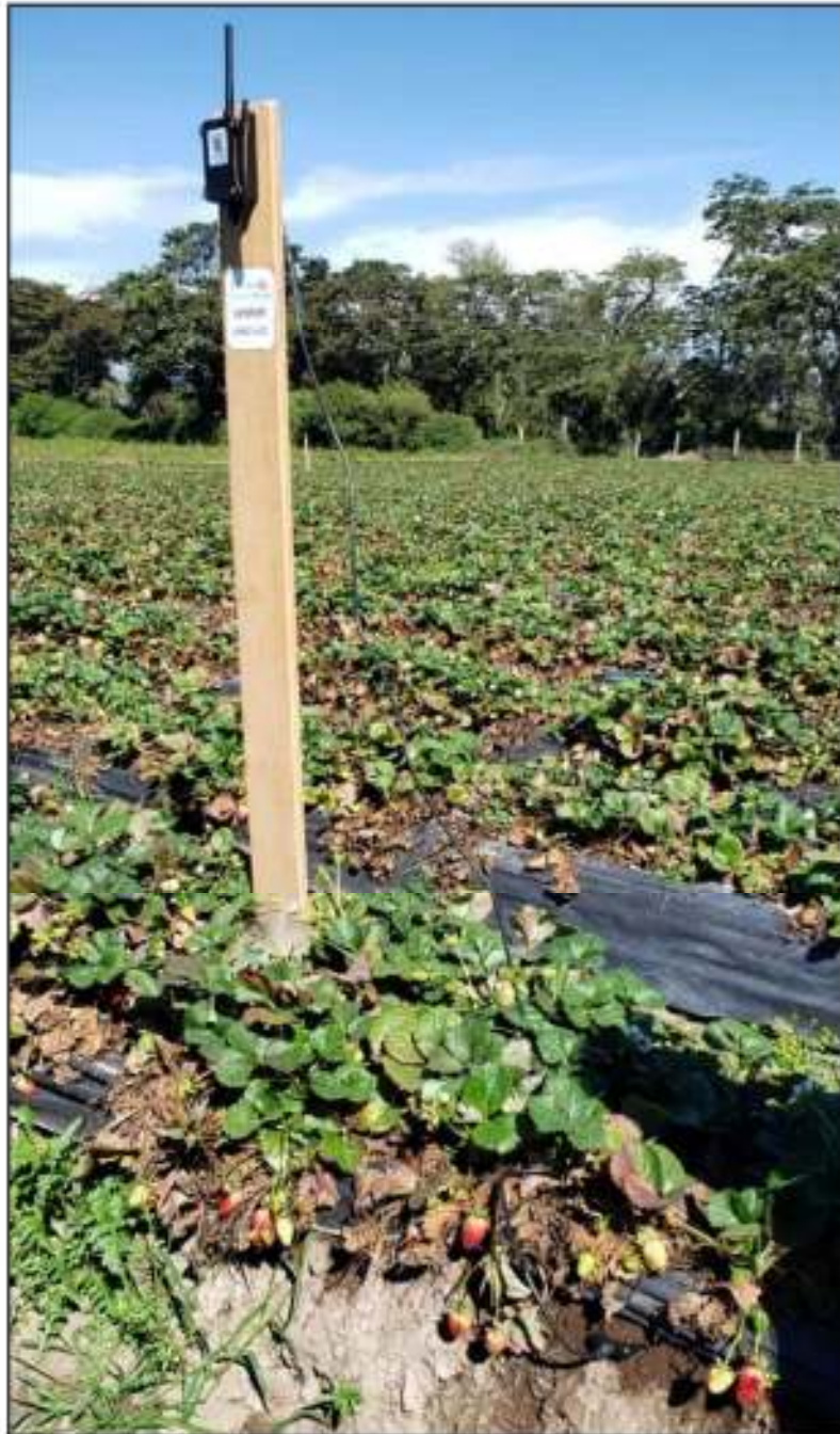
Figura 114. Sensor LSE01-02 instalado en el cultivo de fresas.
