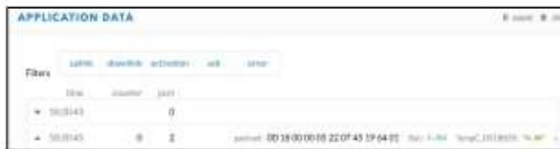
Figura 27. Mensajes intercambiados entre el sensor LSE01-01 y el servidor en el proceso de unión a la red.
