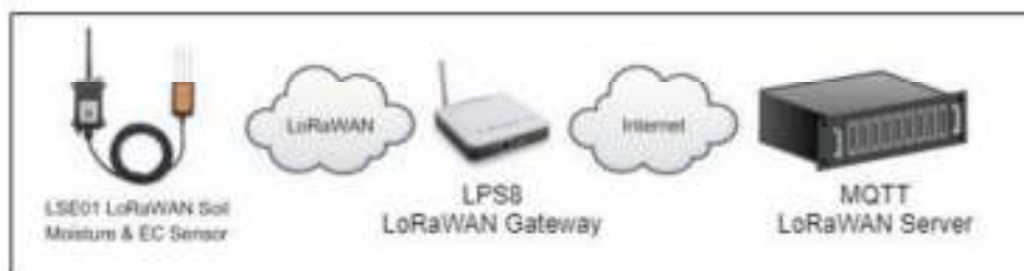
Figura 10. Sensor LSE01 en una red LoRaWAN. Fuente [49].
