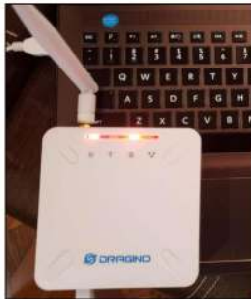
Figura 11. Dispositivo LPS8 encendido.
