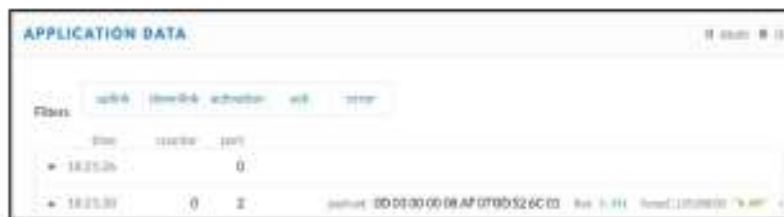
Figura 30. Mensajes intercambiados entre el sensor LSE01-02 y el servidor en el proceso de unión a la red
