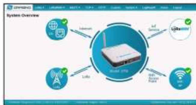
Figura 20. Portal de configuración del dispositivo LPS8 después de la configuración.
