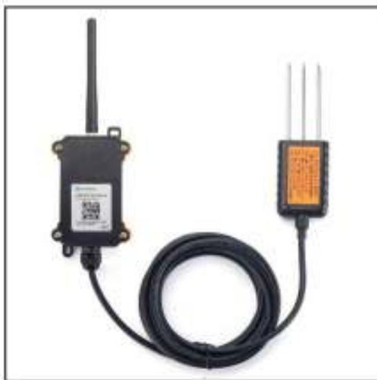
Figura 9. Sensor de humedad del suelo LSE01 LoRaWAN. Fuente [49].
