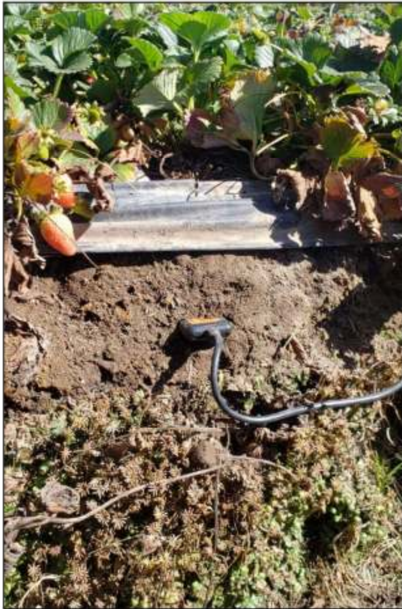
Figura 112. Sensor instalado en el suelo de manera horizontal.
