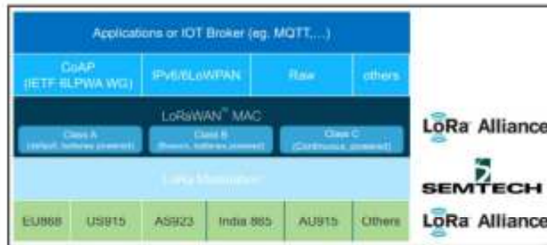
Figura 2. Arquitectura en capas LoRaWAN. Fuente [17].
