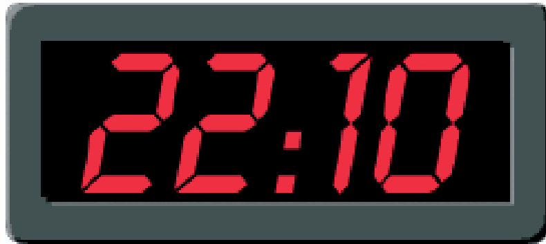
Figura 1.16. Display de 7 segmentos 16
