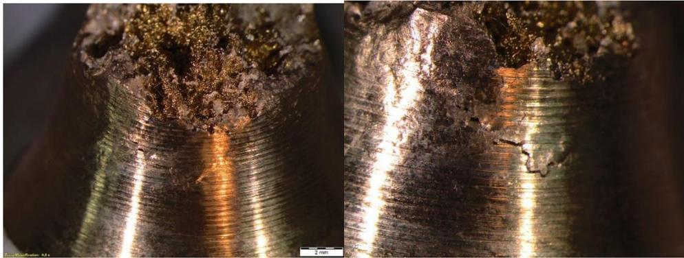
Figura 3.16 Macrografía vista lateral de la probeta con 0.5% de ferro-silicio.
