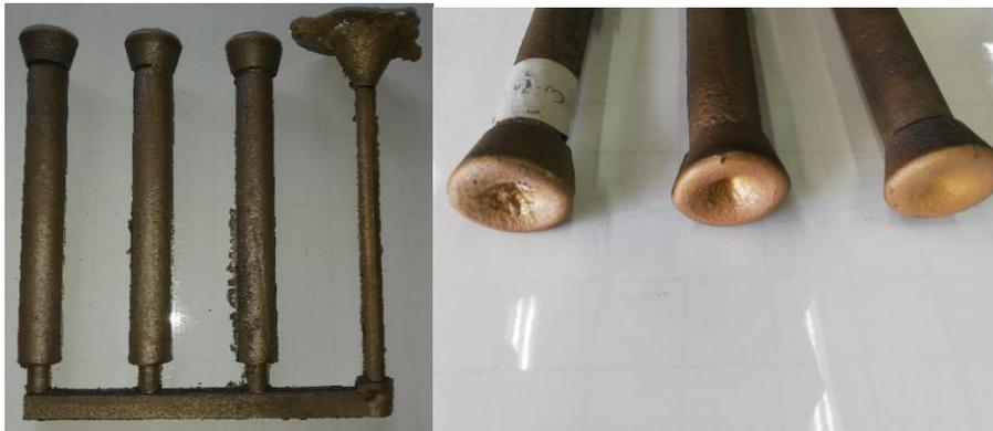
Figura 3.3 Probetas de colado con probetas en posición horizontal
