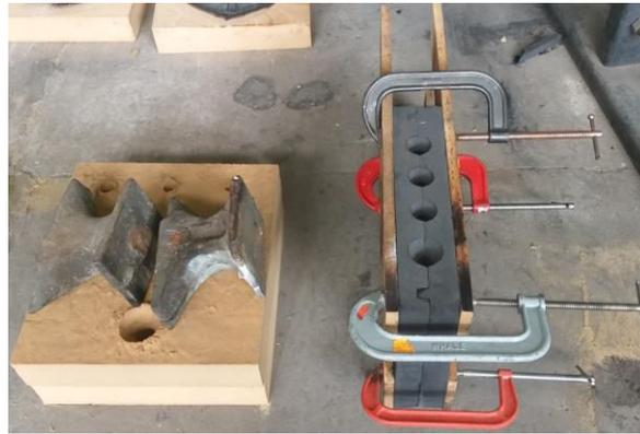
Figura 2.5 Moldes con sistema de alimentación para colado con probetas en posición vertical y horizontal.
