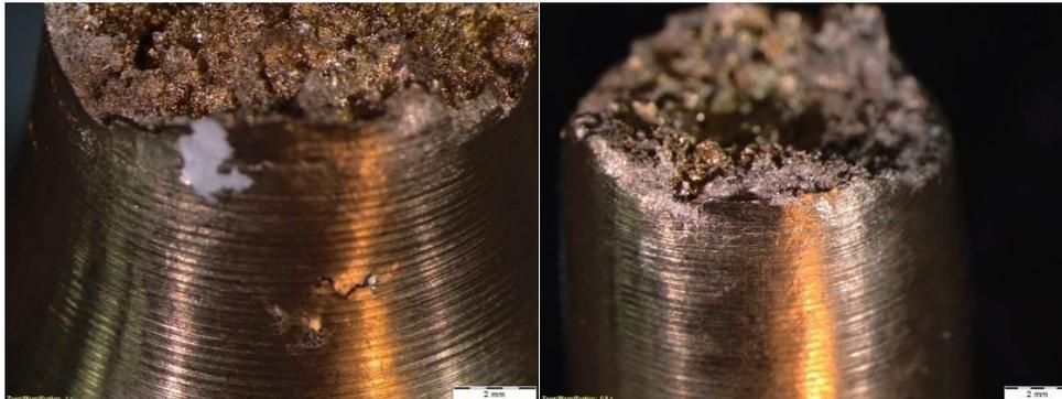
Figura 3.18 Macrografía vista lateral de la probeta con 1.5% de ferro-silicio.
