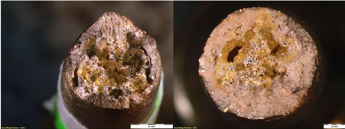
Figura 3.13 Macrografía vista superior de la probeta con 0.5% de silicio.
