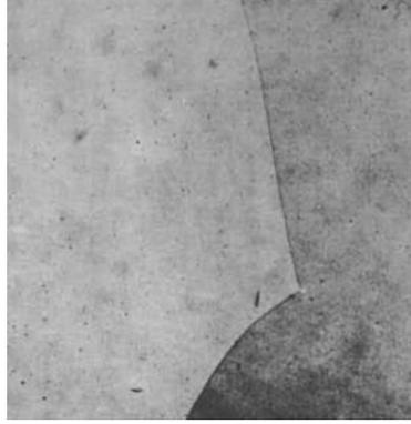
Microestructuras de aleación Cu-42Zn templadas de la región  $\beta$  y luego recalentadas para desarrollar una estructura  $\alpha$  de precipitado. La temperatura de recalentamiento más alta da una estructura más gruesa y por lo tanto un material más blando. Todo  $\beta'$ . Templado desde 800 ° C (1470 ° F) [18].
