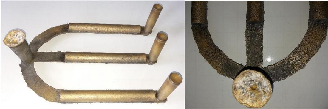
Figura 3.2 Probetas de colado con probetas en posición horizontal.
