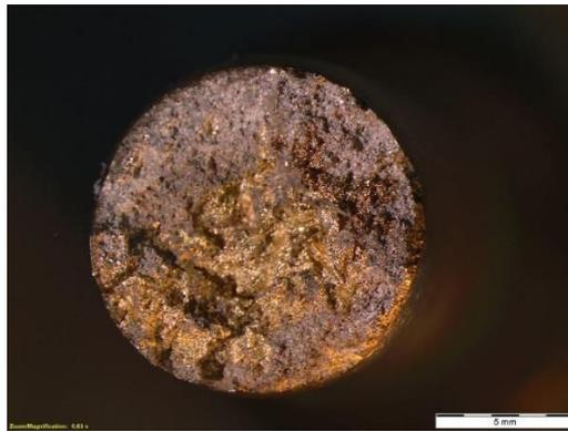
Figura 3.17 Macrografía vista superior de la probeta con 1.5% de ferro-silicio.
