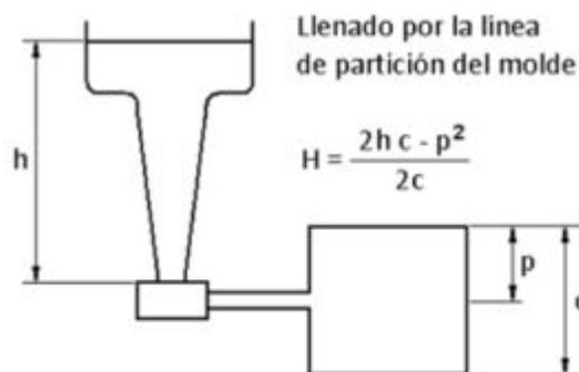
Figura 3. Esquema de llenado del molde por la línea de partición.
