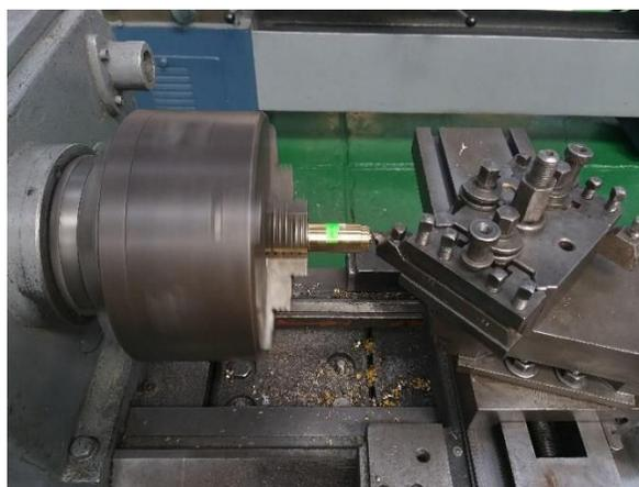
Figura 2.14. Rectificado de las probetas en torno manual.
