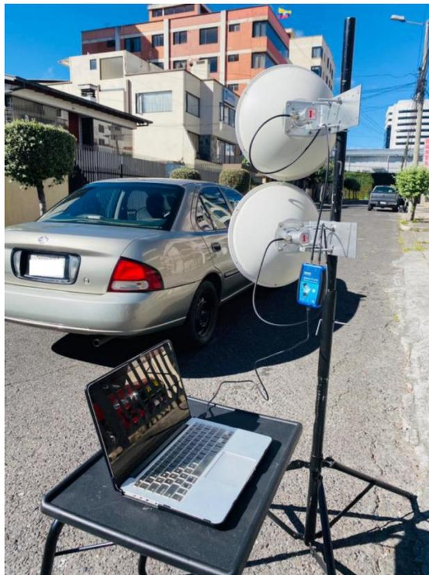
**Figura 3.10.** Implementación del hardware del Radar Doppler CW
