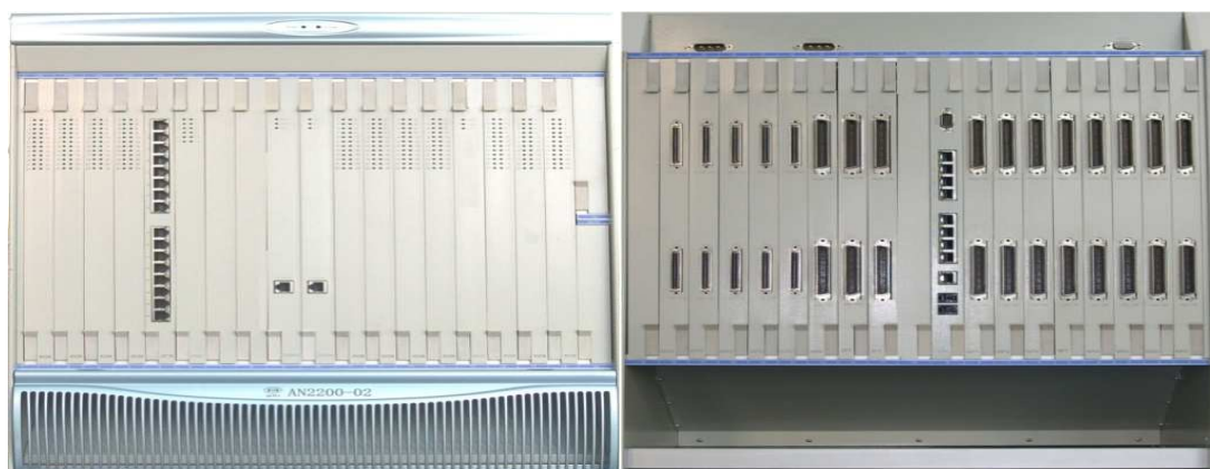
Figura 1.18 Vista frontal y posterior del DSLAM AN2200-02 [22]
