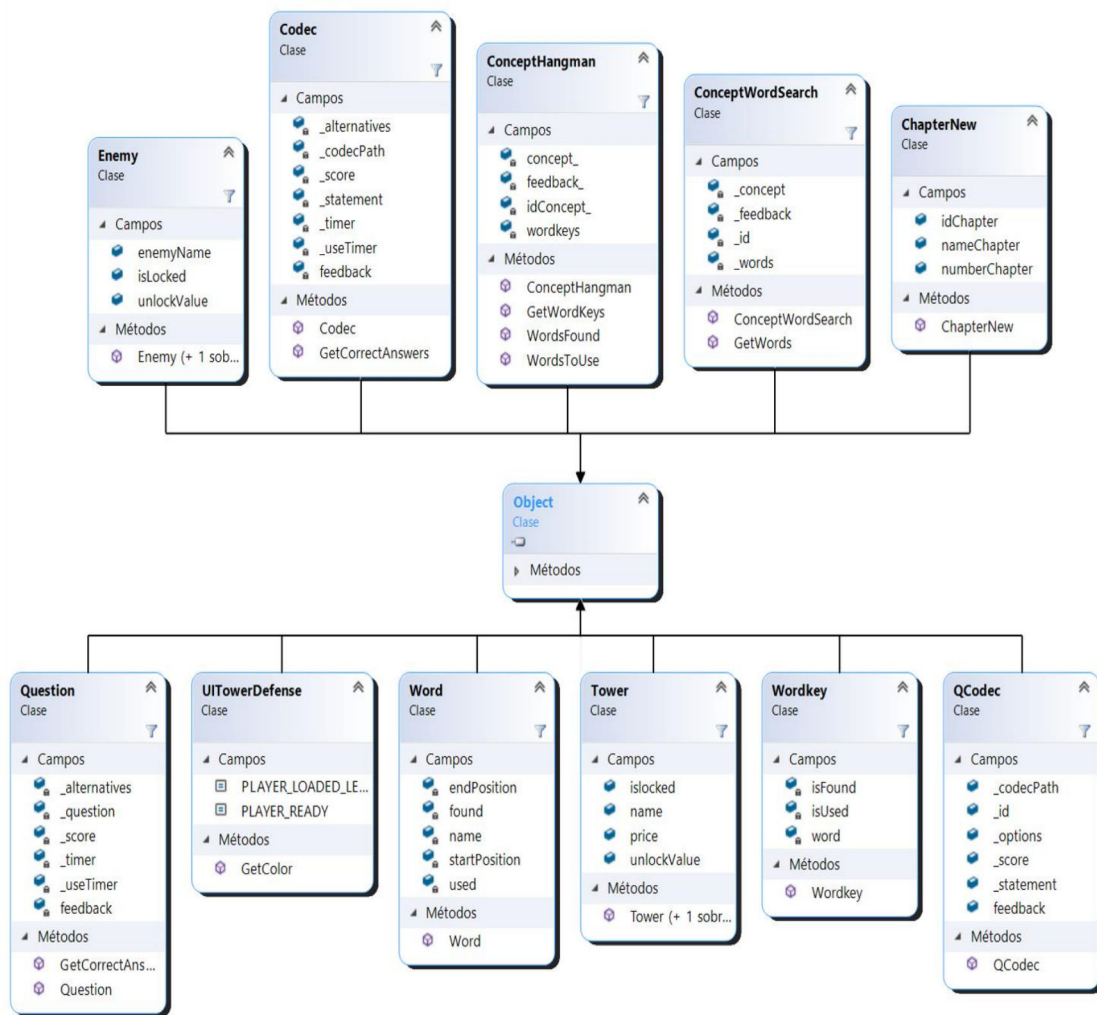
Figura 2.12. Diagrama de clases heredadas de la clase Object
