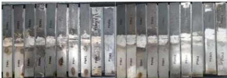
Figura 2.22 - Probetas cortadas para el ensayo de doblado de cara-raíz en placas. (Fuente Propia, 2020)
