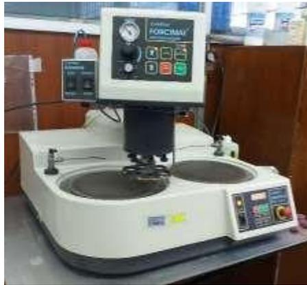
**Figura 2.28** - Pulidor de probetas.
