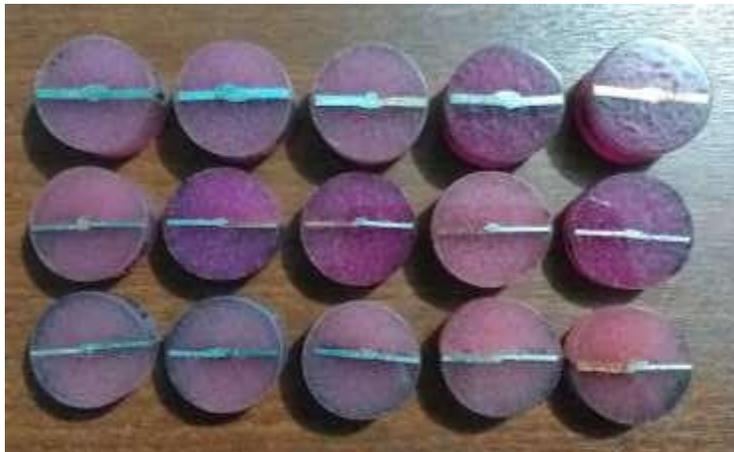
**Figura 2.29** - Muestras pulidas y atacadas químicamente.
