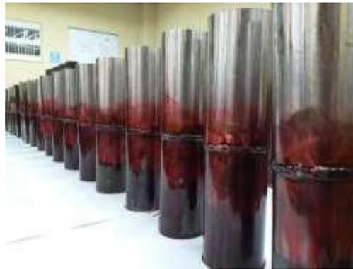
**Figura 2.12** - Penetrante colocado en tubería.
