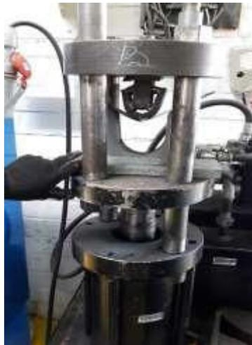
**Figura 2.26** - Prensa hidráulica para el ensayo de doblado.
