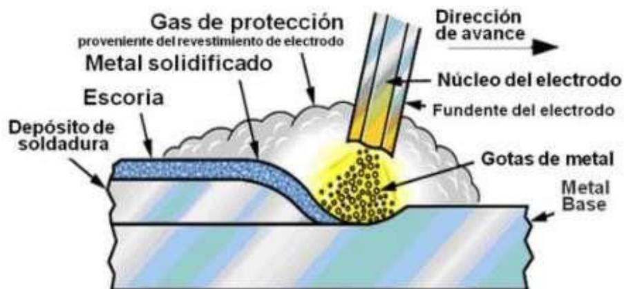
**Figura 1.6** - Diagrama de proceso de soldadura
