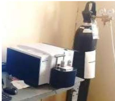
**Figura 2.9** - Equipo para determinar la composición química.
