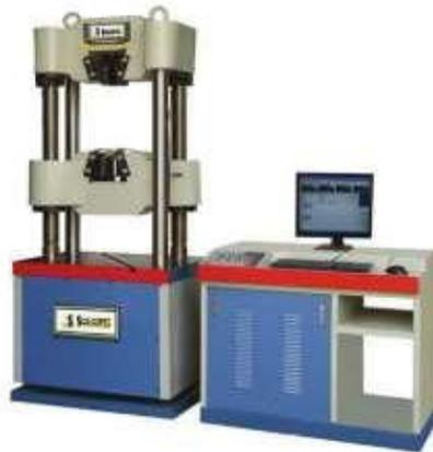
**Figura 1.12** - Máquina universal de ensayos
