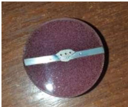
**Figura 2.33 - Probeta para análisis de dureza.**
