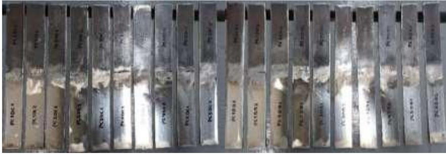
**Figura 2.23** - Probetas cortadas para el ensayo de doblado de cara-raíz en tubería cuadrada.
