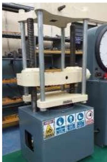
**Figura 2.20** - Máquina universal para el ensayo de tracción.
