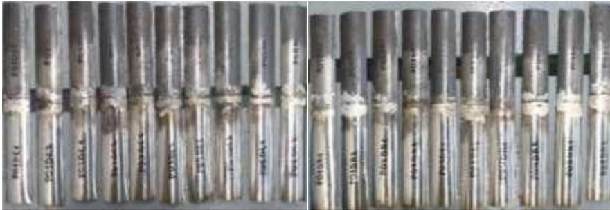
**Figura 2.24** - Probetas cortadas para el ensayo de doblado de cara-raíz en tubería redonda.
