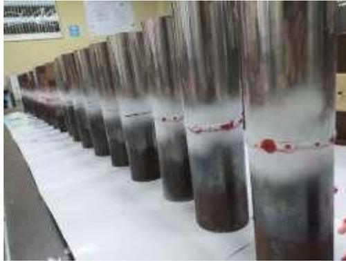
**Figura 2.13** - Revelador colocado en tubería.
