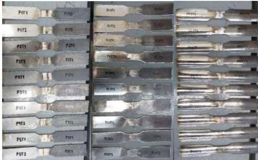
**Figura 2.19** - Probetas de tensión placas, tubería cuadrada y redonda.
