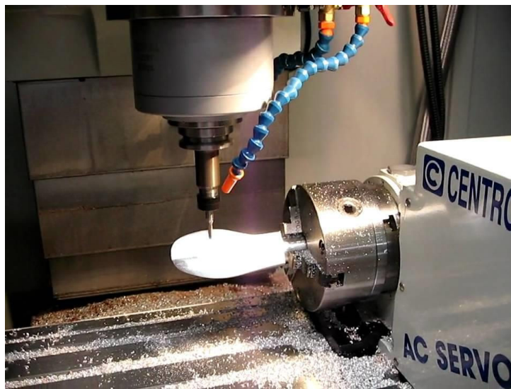
Figura 1.3. Eje de rotación A (Centroid M400) en centro de mecanizado [8].
