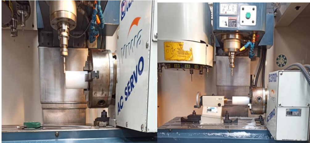
Figura 3.81. Cero pieza en cilindro prismático y paso helicoidal con el cuarto eje [Fuente: Propia].
