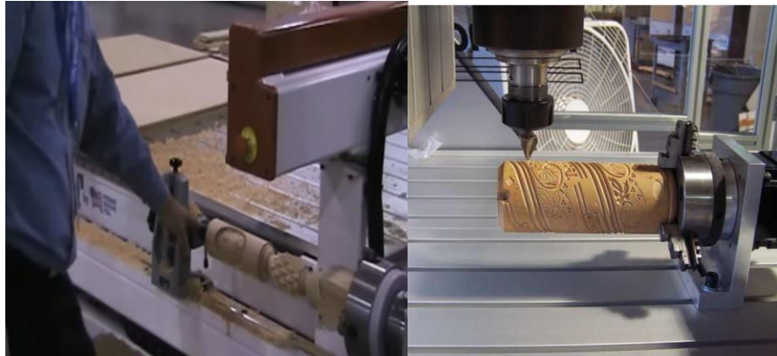
Figura 1.14. Aplicaciones arquitectónicas a) Grabados y b) formas en columnas [12].
