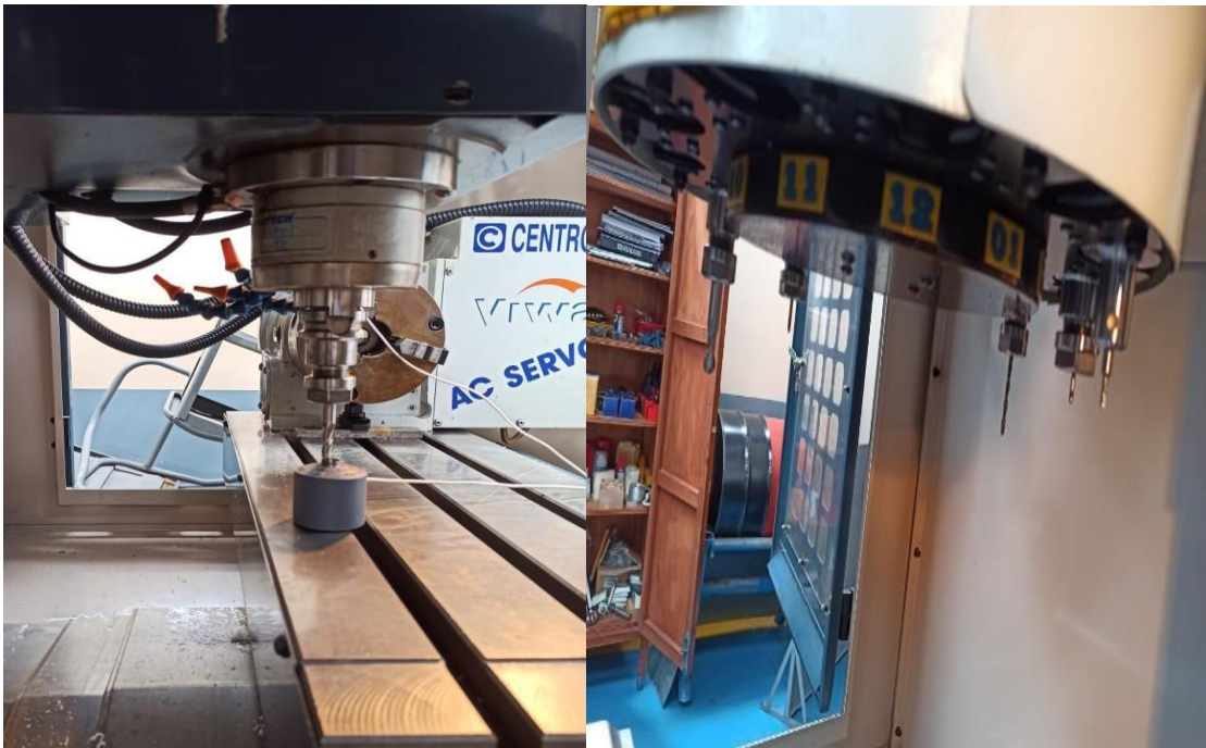
Figura 3.80. Medición de todas las herramientas a usar durante el mecanizado [Fuente: Propia].
