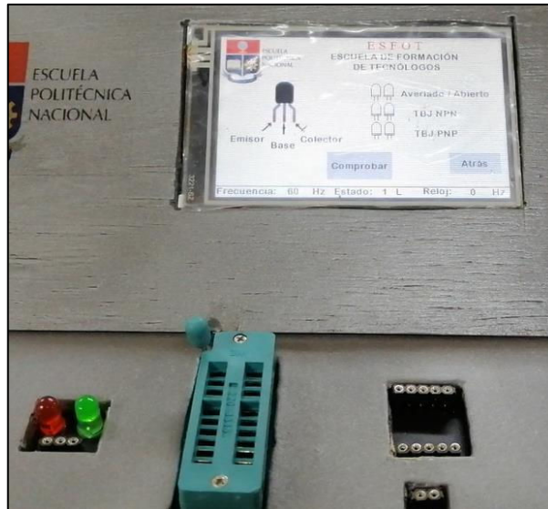
Figura 3.64: Comprobador de transistores
