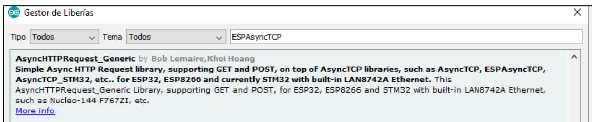
Figura 3.42: Instalación de librería ESPAsyncTCP
