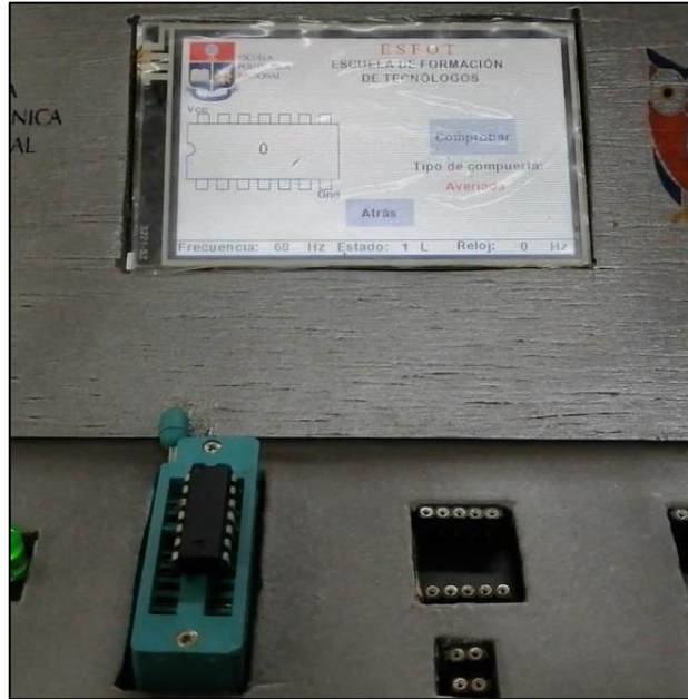
Figura 3.63: Comprobador de compuertas
