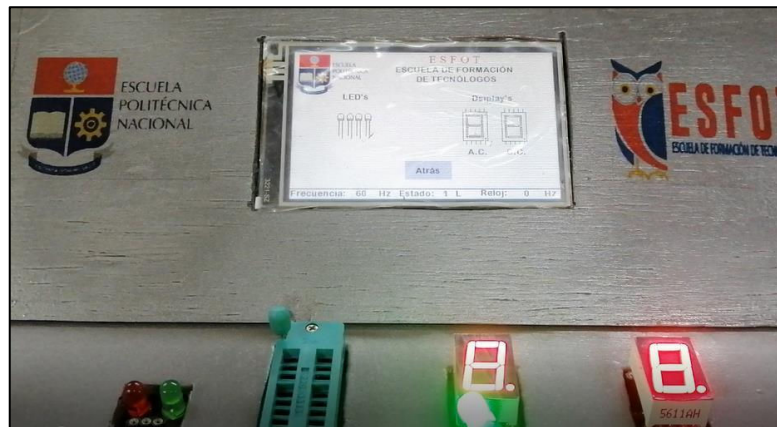
Figura 3.62: Comprobador de LEDs y displays
