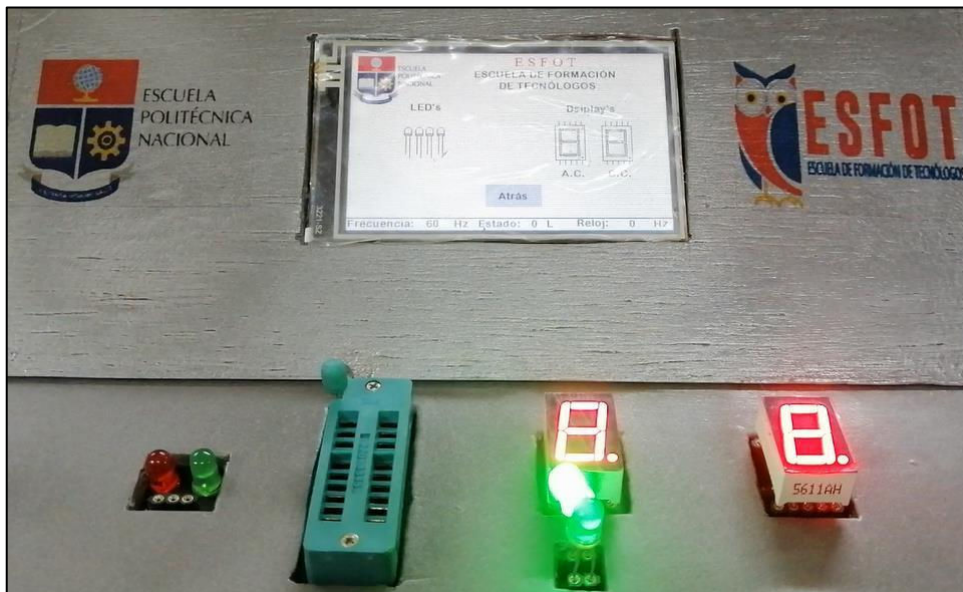
Figura 3.23: Módulo entrenador, comprobador de LEDs
