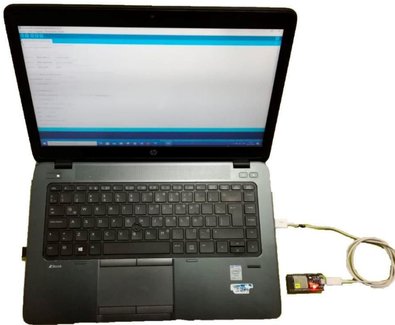
Figura 2.6. Conexión física entre el ordenador y NodeMCU ESP32.
