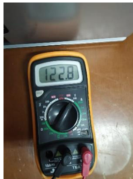
Figura 3.21 Prueba de voltaje en tomacorriente.
