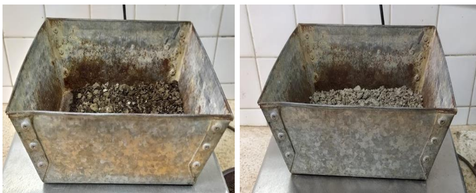
Fotografía 33. Muestra de agregado grueso húmedo y seco Elaborado por: Aigaje y Chalco (2021)
