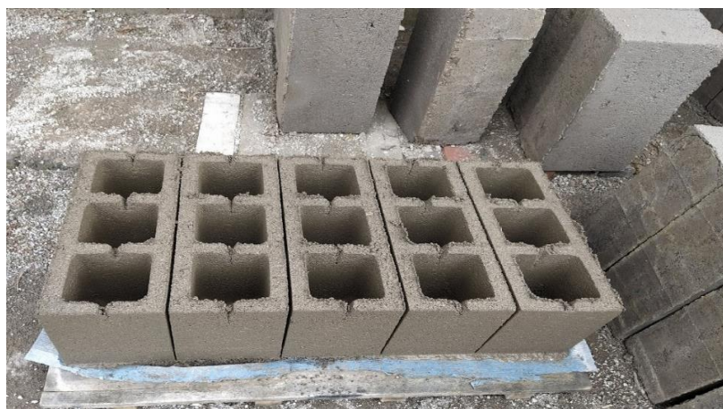
Fotografía 1. Bloques huecos de hormigón de dimensiones 15x20x40 cm Elaborado por: Aigaje y Chalco (2021)
