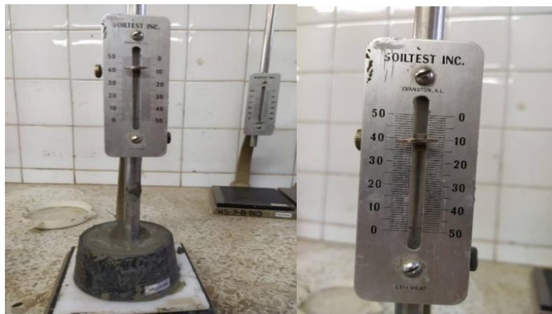
Fotografía 19. Penetración del vástago en la pasta de cemento Elaborado por: Aigaje y Chalco (2021)
