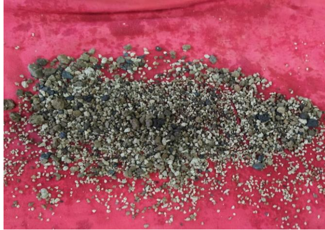
Fotografía 28. Condiciones SSS en el agregado grueso Elaborado por: Aigaje y Chalco (2021)
