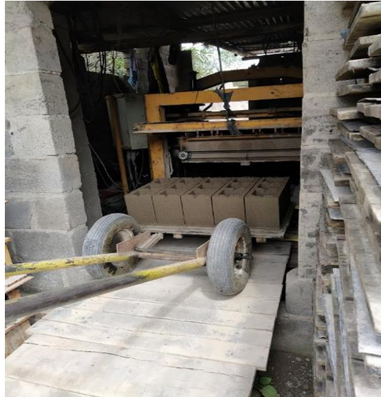
Fotografía 9. Retiro de los bloques huecos de hormigón fabricados ELABORADO POR: Aigaje y Chalco (2021)
