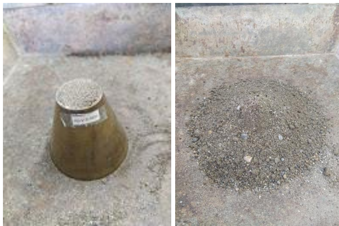
Fotografía 21. Condición SSS en el agregado fino Elaborado por: Aigaje y Chalco (2021)
