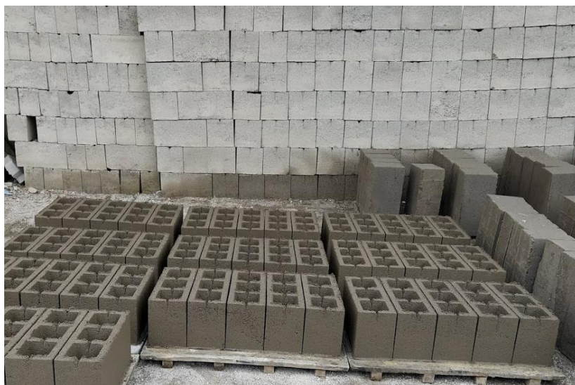
Fotografía 3. Bloques huecos de hormigón prensados alivianados sin norma y bajo costo de producción. Elaborado por: Aigaje y Chalco (2021)
