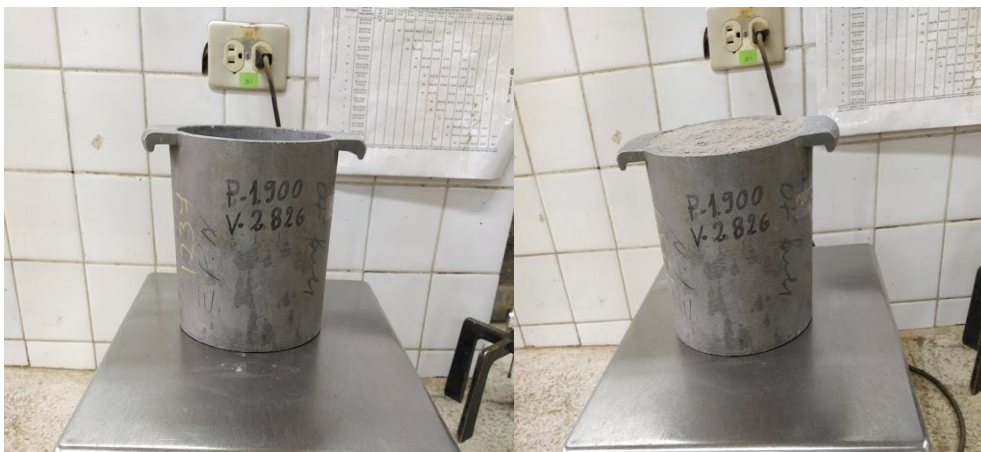
Fotografía 23. Densidad suelta y compactada del agregado fino Elaborado por: Aigaje y Chalco (2021)
