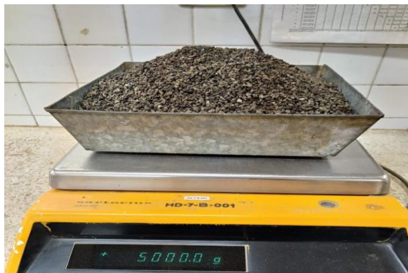
Fotografía 34. Muestra para el ensayo de abrasión de agregado grueso Elaborado por: Aigaje y Chalco (2021)
