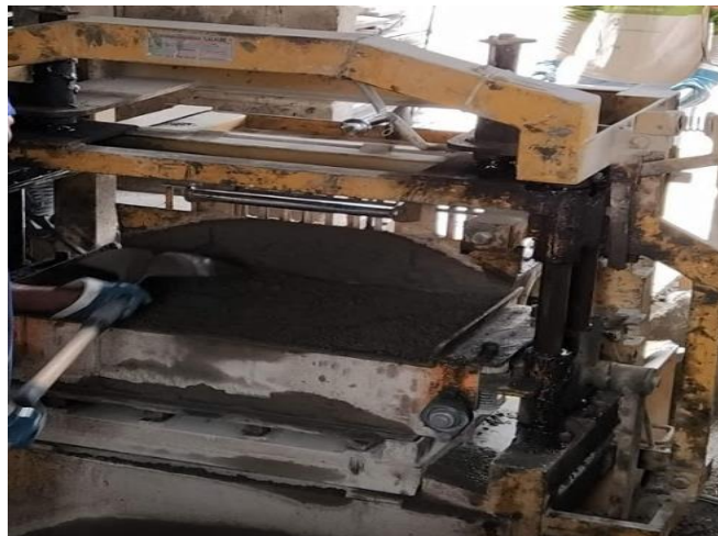
Fotografía 7. Fabricación de bloques huecos de hormigón Elaborado por: Aigaje y Chalco (2021)
