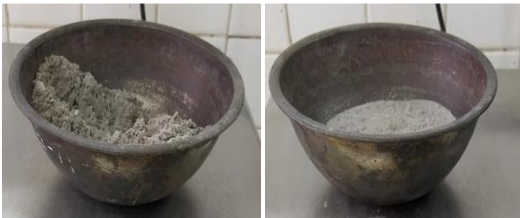
Fotografía 25. Agregado fino en condiciones normales y la muestra secada en horno Elaborado por: Aigaje y Chalco (2021)
