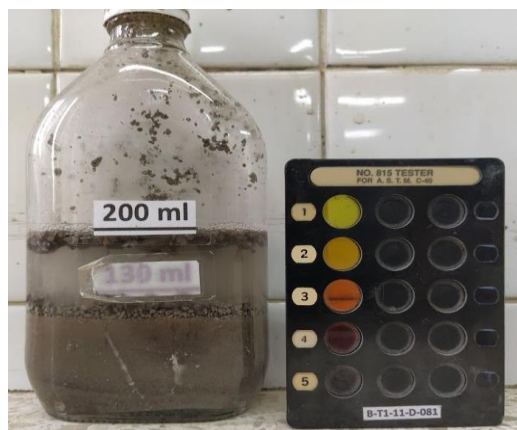
Fotografía 26. Ensayo de contenido orgánico con placa de Gardner. Elaborado por: Aigaje y Chalco (2021)
