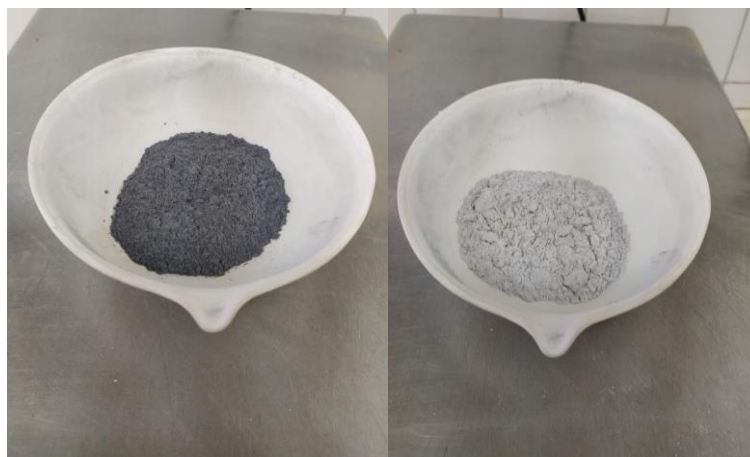
Fotografía 15. Resultado de la quema en horno de leña y en mufla. Elaborado por: Aigaje y Chalco (2021)
