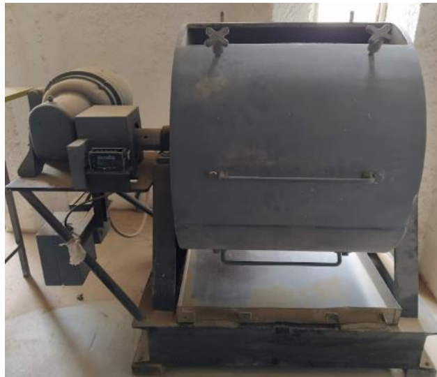
Fotografía 35. Máquina de los Ángeles para ensayo de abrasión de agregado grueso Elaborado por: Aigaje y Chalco (2021)
