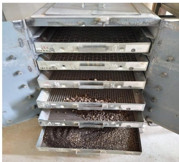
Fotografía 32. Granulometría de agregado grueso Elaborado por: Aigaje y Chalco (2021)
