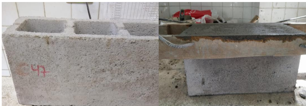
Fotografía 40. Refrentado de una de las caras del bloque hueco Elaborado por: Aigaje y Chalco (2021)
