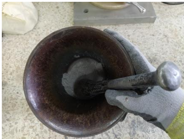
Fotografía 16. Proceso de moler la (CCA) en mortero.
