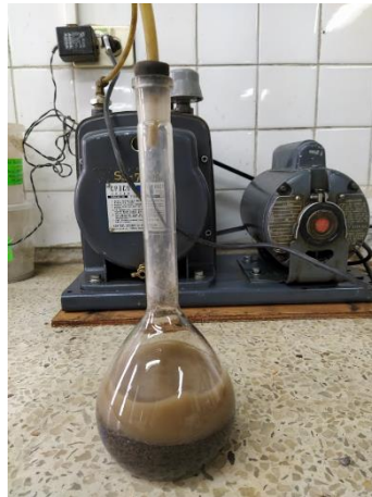
Fotografía 22. Extracción de aire de la muestra Elaborado por: Aigaje y Chalco (2021)
