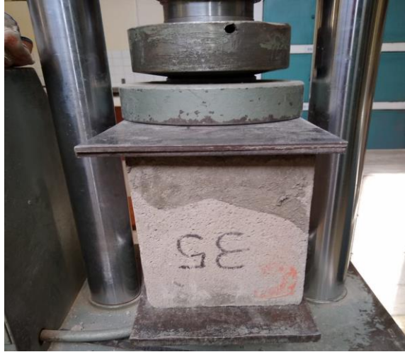
Fotografía 41. Posición del bloque hueco de hormigón para el ensayo a compresión simple Elaborado por: Aigaje y Chalco (2021)
