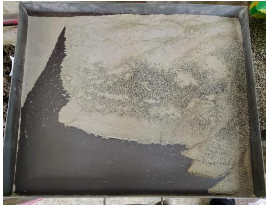
Fotografía 37. Material resultante del desgaste del agregado grueso.
