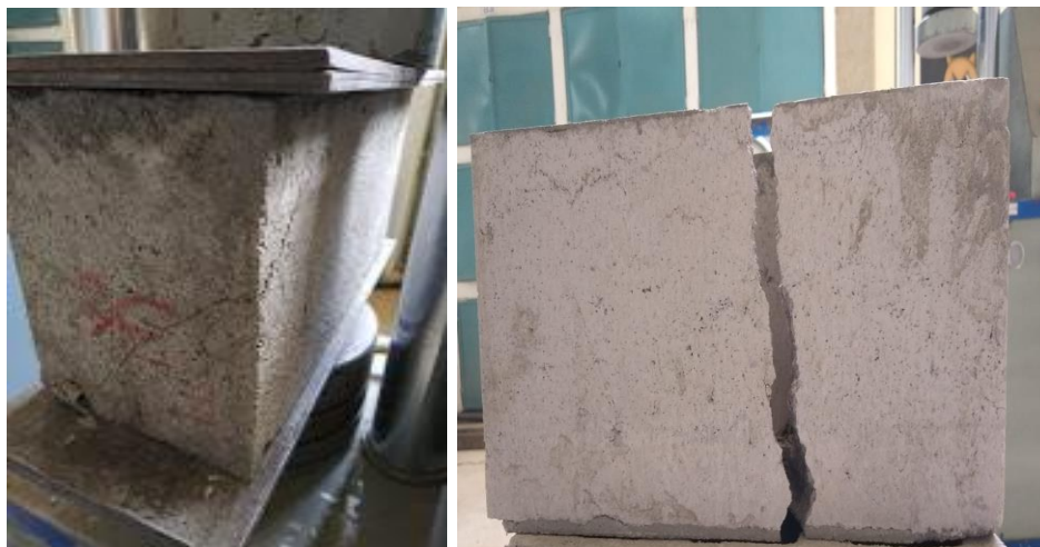
Fotografía 42. Rotura en ensayo de compresión simple Elaborado por: Aigaje y Chalco (2021)
