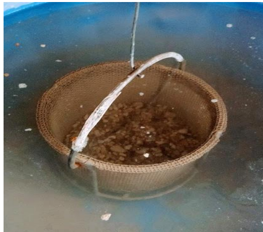
Fotografía 29. Muestra de agregado grueso sumergido en agua en condiciones SSS Elaborado por: Aigaje y Chalco (2021)
