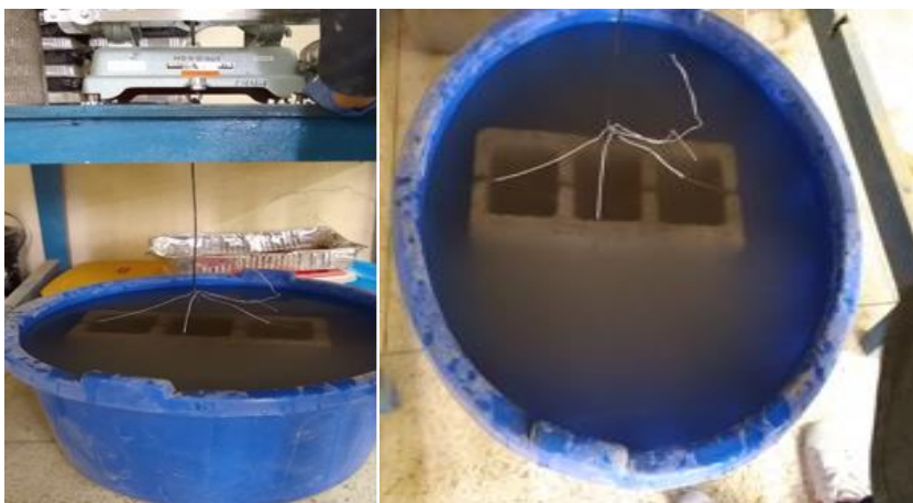
Fotografía 39. Ensayo de Absorción determinación del peso sumergido Elaborado por: Aigaje y Chalco (2021)
