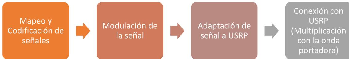
**Figura 2.35.** Diagrama de bloques del modulador a implementar
