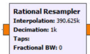
Figura 3.10. Cambio de frecuencia de muestreo de la señal
