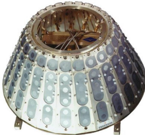
Figura 1.9. Arreglo conformado para comunicaciones satelitales en órbita baja con frecuencia de operación de 8 GHz [16].
