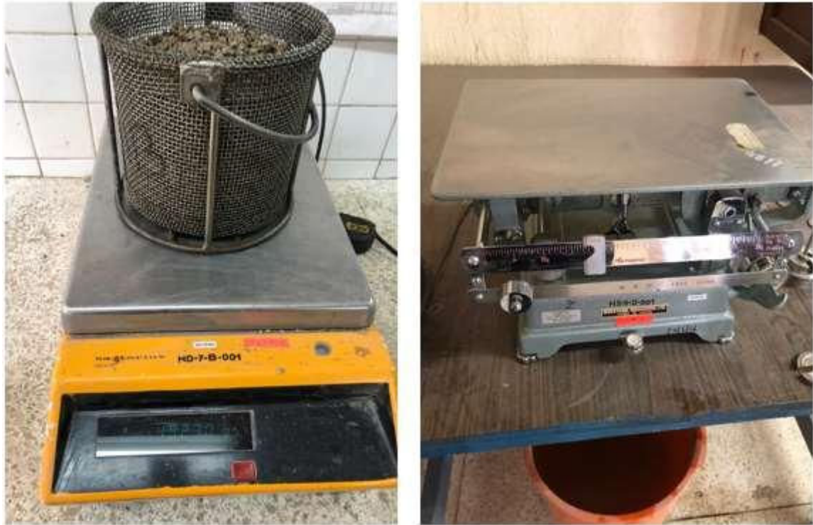
Figura 14: Procedimiento de ensayo de gravedad específico en áridos gruesos
