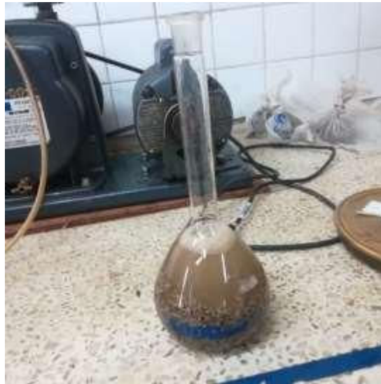
Figura 10: Ensayo para determinación de la gravedad específica mediante picnómetro
