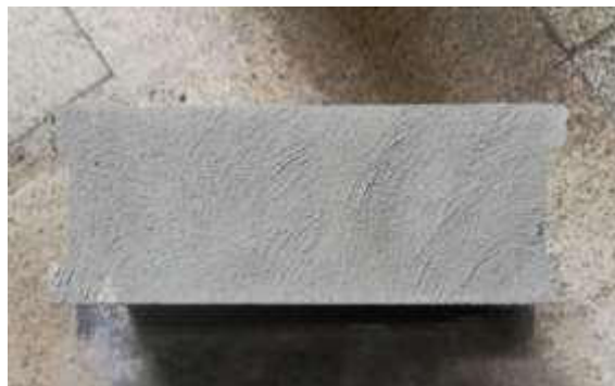
Figura 27: Refrentado de bloque para correcta distribución de carga
