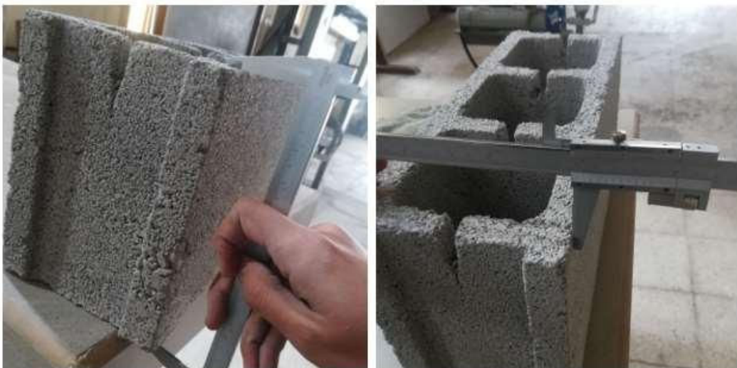
Figura 25: Medición de bloques para cálculo de área neta
