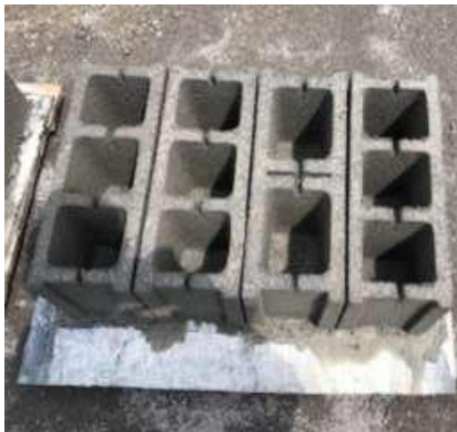
Figura 7: Desmolde de Bloques
