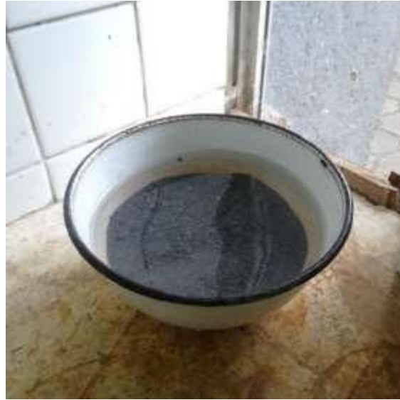
Figura 8: Muestra lavada de Polvo Azul siguiendo norma (NTE INEN 697)
