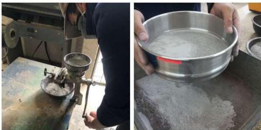
Figura 21: Trituración y tamizado de ceniza volcánica
