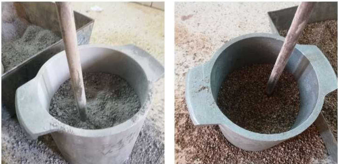
Figura 11: Ensayo de densidad aparente compactada de polvo azul y chasqui fino
