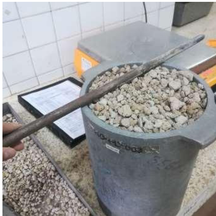
Figura 15: Ensayo de Densidad Compactada
