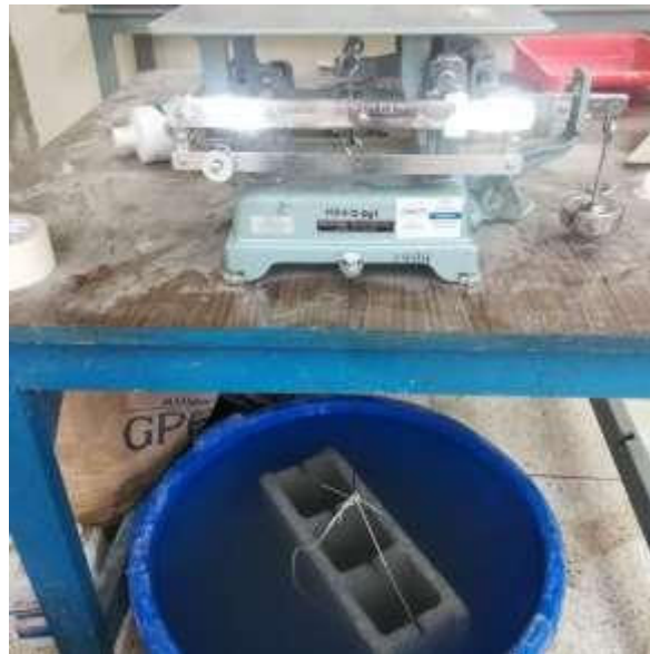
Figura 24: Medición del peso del bloque sumergido
