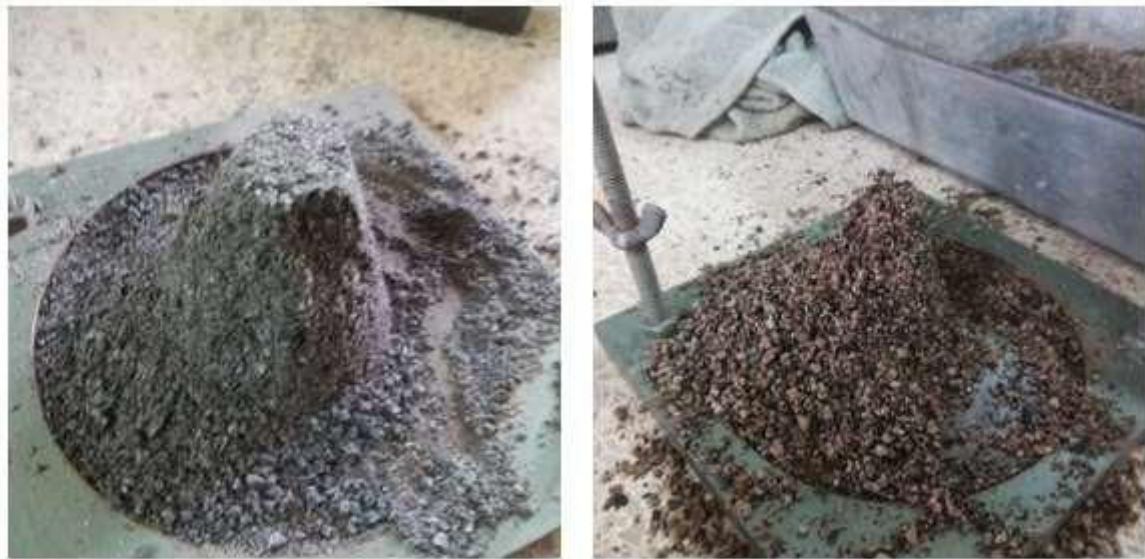
Figura 9: Ensayo para la determinación de la condición SSS del polvo azul y chasqui
