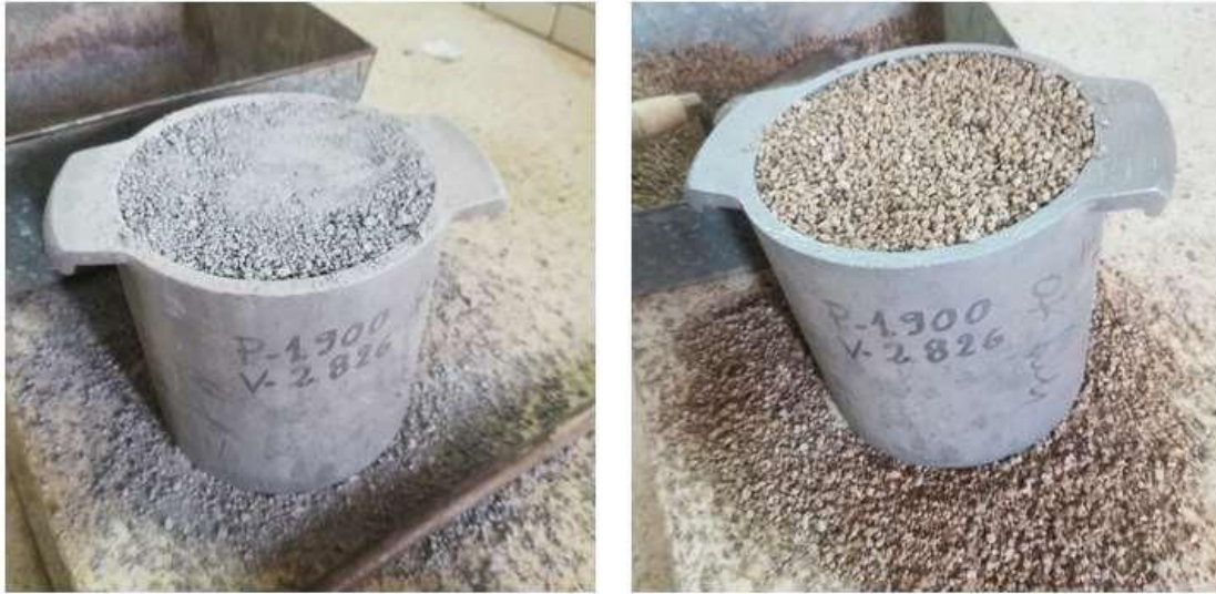
Figura 12: Ensayo de densidad aparente suelta del polvo azul y chasqui fino
