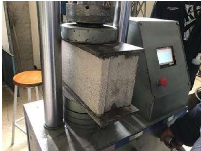
Figura 28: Ensayo a compresión de bloque
