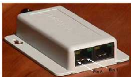
Figura 2.60 AA-R500 detalle de los pines
