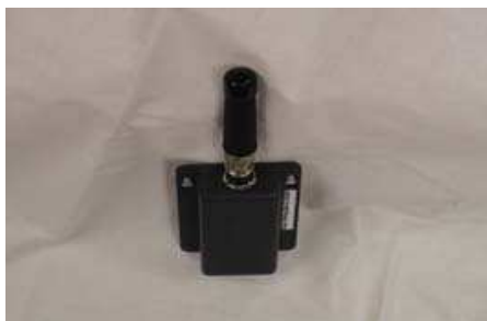
Figura 2. 2 El W-RX201 Lector Wavetrend con una antena conectada a él.
