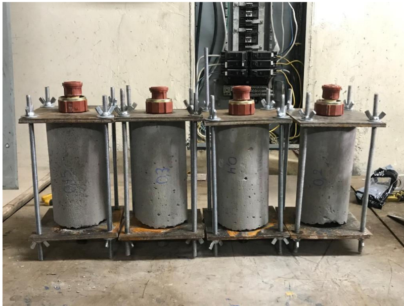
Figura 16 Armado del ensayo de permeabilidad Elaborado por: (Patricio Ramos, 2020)
