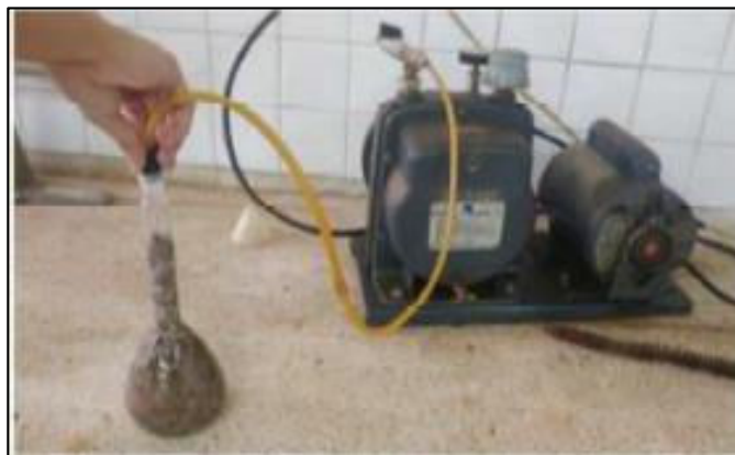
Figura 6 Aplicación de vacío al picnómetro Elaborado por: (Patricio Ramos, 2020)
