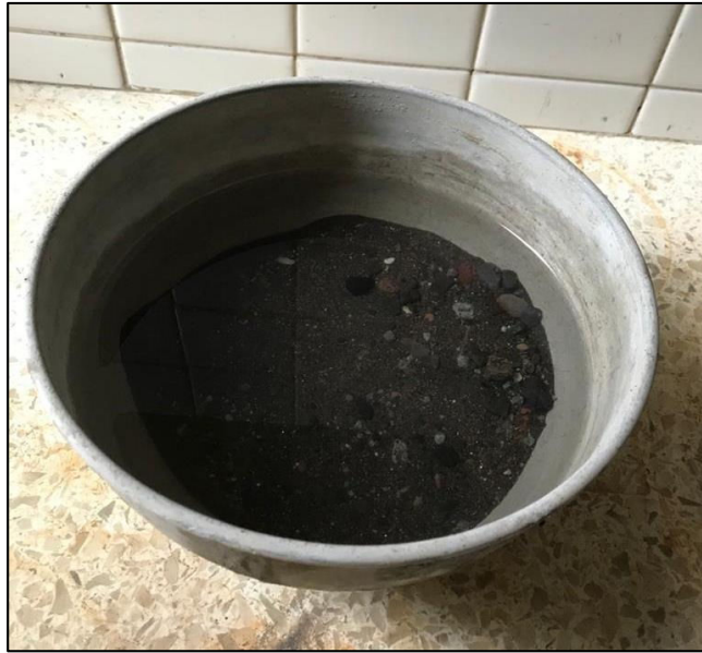
Figura 3 Agregado fino lavado y sumergido Elaborado por: (Patricio Ramos, 2020)
