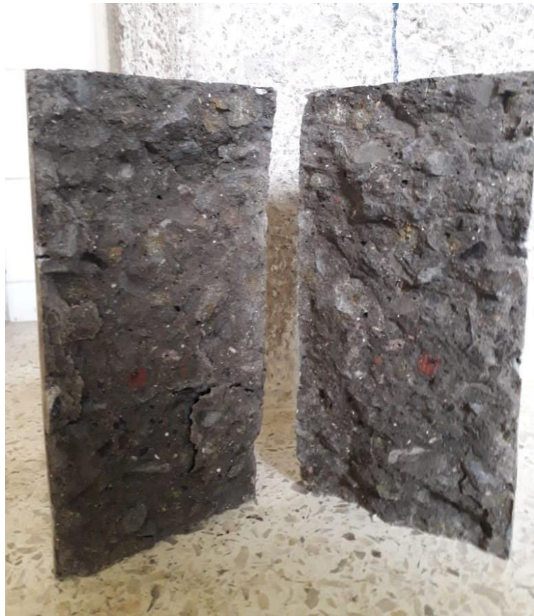
Figura 15 Modo de falla de Tracción indirecta Elaborado por: (Patricio Ramos, 2020)
