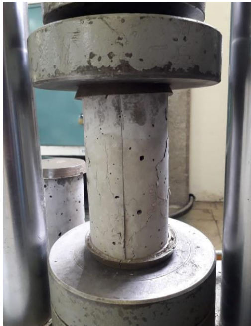
Figura 12 Ensayo de compresión Elaborado por: (Patricio Ramos, 2020)
