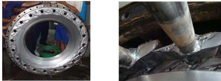
Figura 2. 5 Daño de desgaste de la turbina en la planta de energía de Jhimruk. Fuente: (“Nepal - Jhimruk,” 2018)
