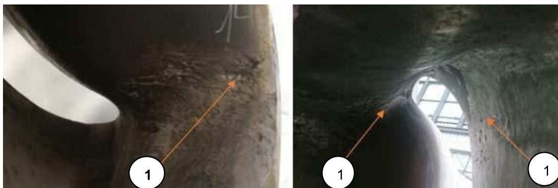
Figura 3. 17 Erosión generada en la Francis de Agoyan a lo largo del Alabe Fuente: (Turbina Francis Agoyán, estudio de campo)
