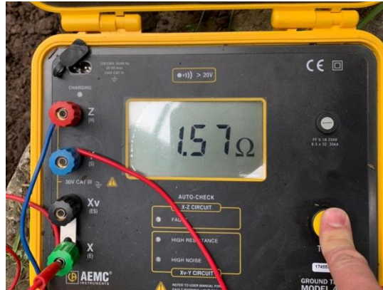
Figura 3.14 Medición de resistencia dirección 1
