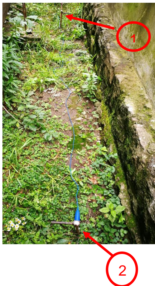
Figura 3.13 Medición de resistividad utilizando el método de Wenner
