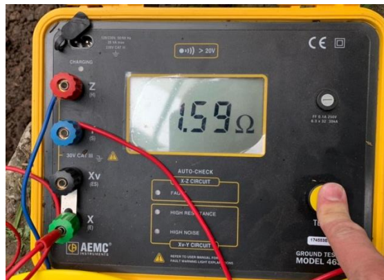
Figura 3.15 Medición de resistencia dirección 2
