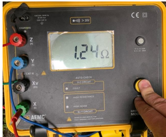
Figura 3.11 Medición de resistencia de la puesta a tierra
