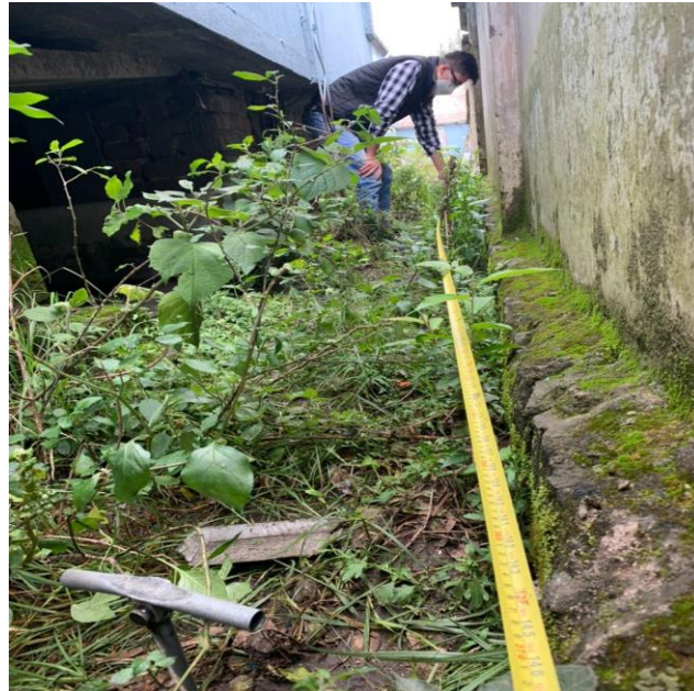
Figura 3.10 Distancia entre electrodos del 62% utilizando el método de los 3 polos
