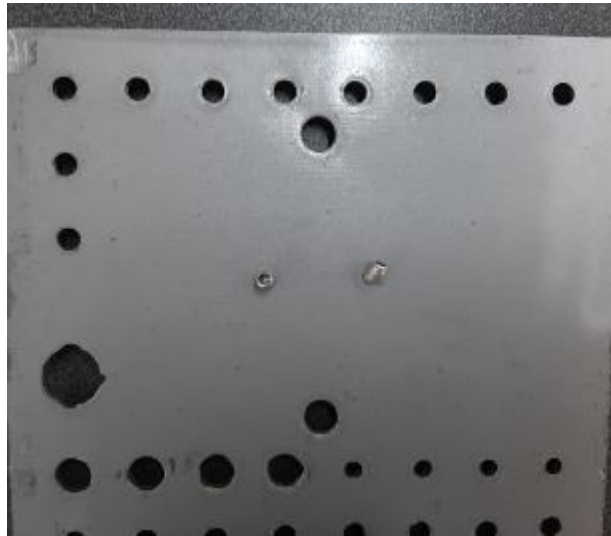
Figura 3.13 Lámina de aleación de aluminio cortada y perforada.
