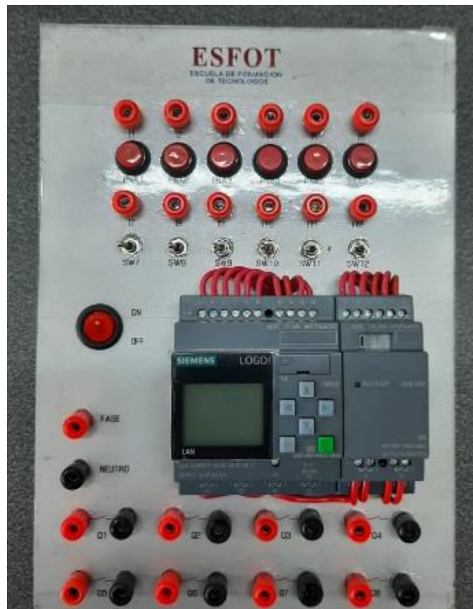
Figura 3.15 Placa de los módulos LOGO 230 RCE y DM8 230R.
