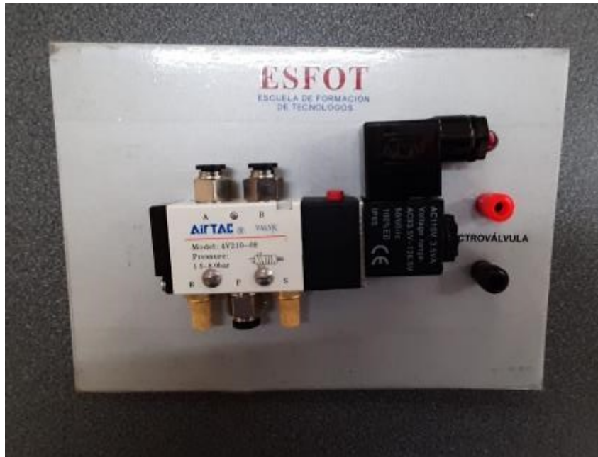
Figura 3.16 Placa de la electroválvula 4V21008CG.
