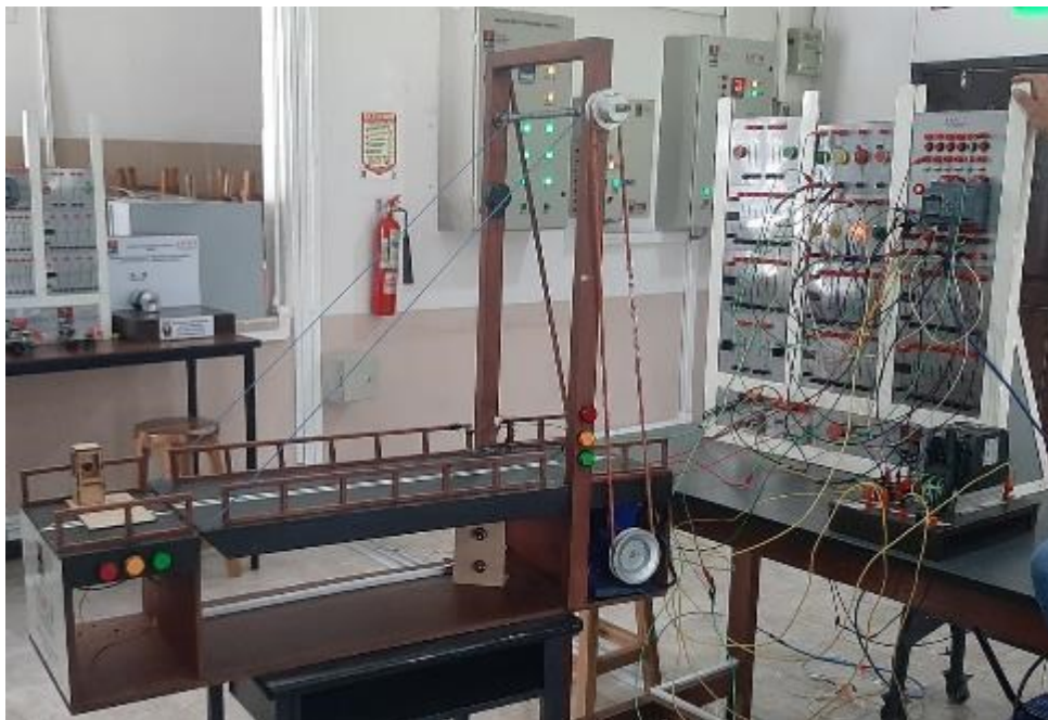
Figura 3.25 Prueba de funcionamiento del puente elevadizo.
