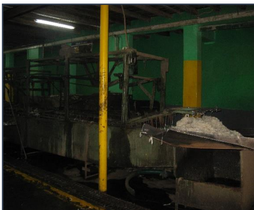
Figura 12. Lavadora de agua fría y agua caliente – Elaboración propia
