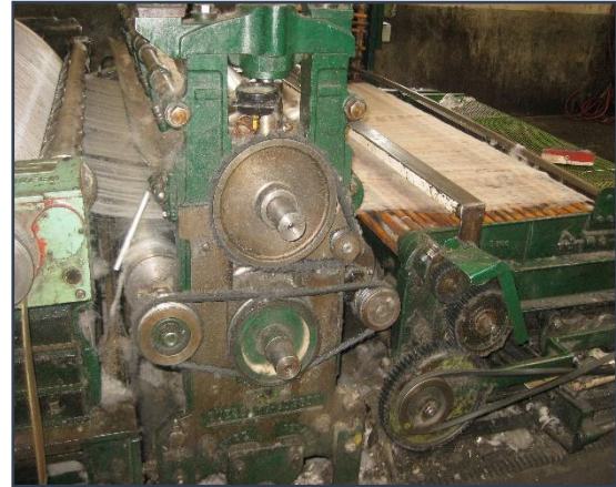
Figura 20. Lana en proceso en Carda Repasadora – Elaboración propia
