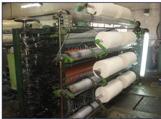
Figura 21. Salida de lana de Carda Mechera Elaboración propia
