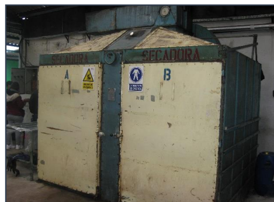
Figura 28. Secadora de tinturado Elaboración propia
