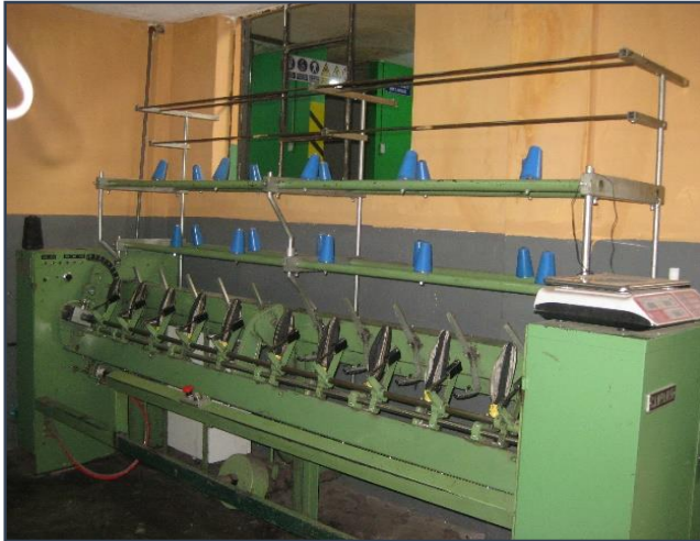
Figura 32. Máquina Ovilladora Elaboración propia
