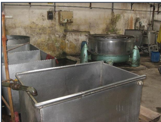
Figura 27. Tinajas de tinturado y centrifugadora – Elaboración propia
