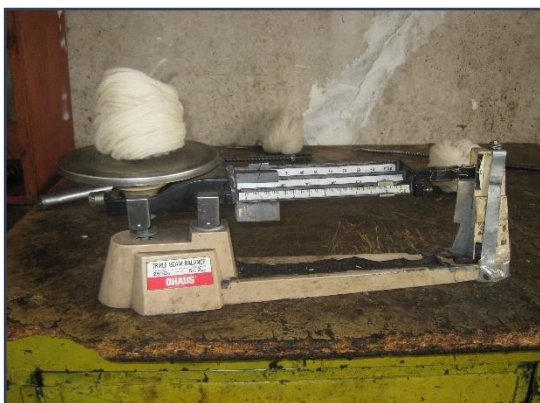
Figura 22. Balanza control de calidad lana cardada – Elaboración propia
