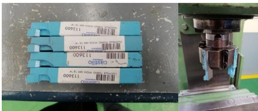
Figura 2.8. Montaje de cuchillas en la herramienta de fresado (Fuente: Propia)
