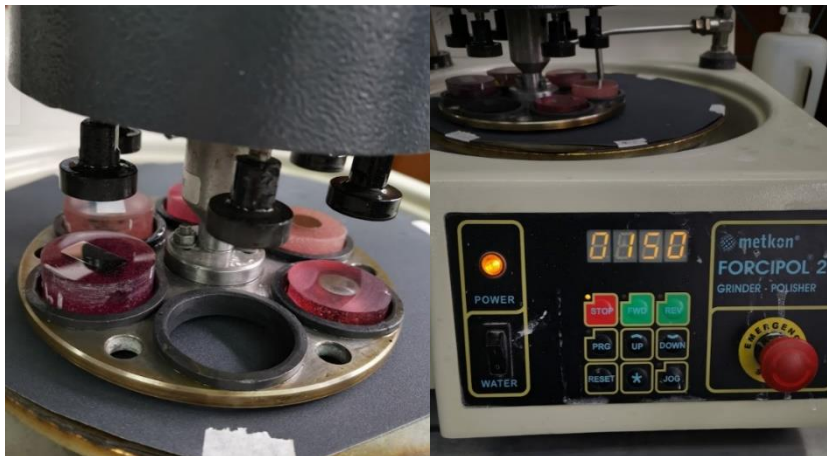
Figura 2.25. Disposición de probetas para el ensayo de desgaste (Fuente: Propia)
