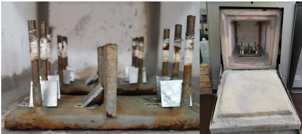
Figura 2.30. Disposición de probetas para el ensayo de adherencia por temperatura (Fuente: Propia)
