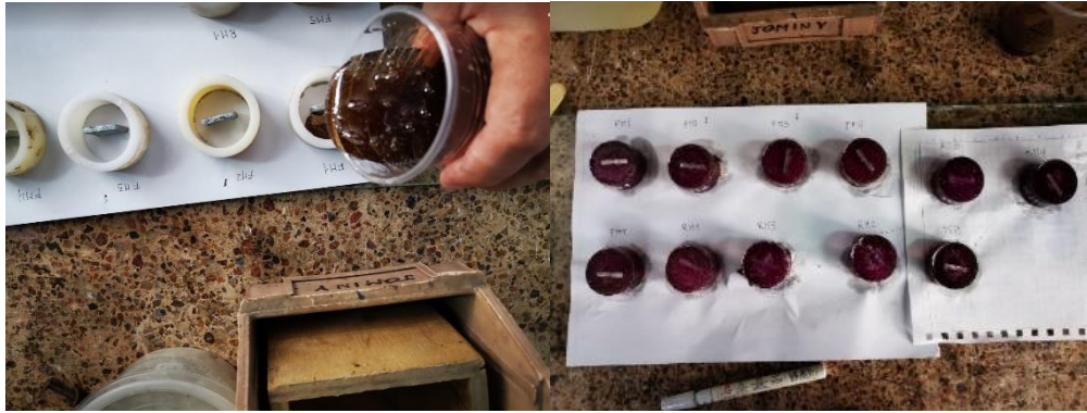
Figura 2.22. Colocación y secado de resina en moldes de duralón (Fuente: Propia)
