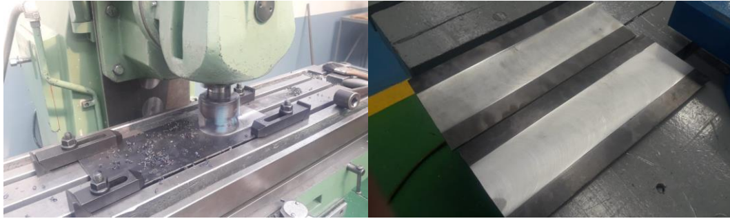
Figura 2.10. Fresado de placas y muestra final (Fuente: Propia)
