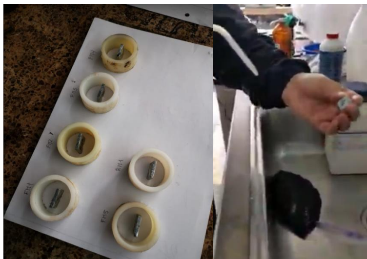
Figura 2.21. Limpieza de probetas para posicionar en el molde de duralón (Fuente: Propia)
