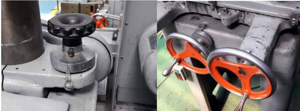
Figura 2.12. Graduación y avance por dial y volantes (Fuente: Propia)
