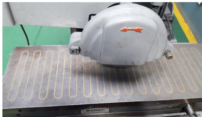
Figura 2.11. Mesa magnética y disco abrasivo (Fuente: Propia)
