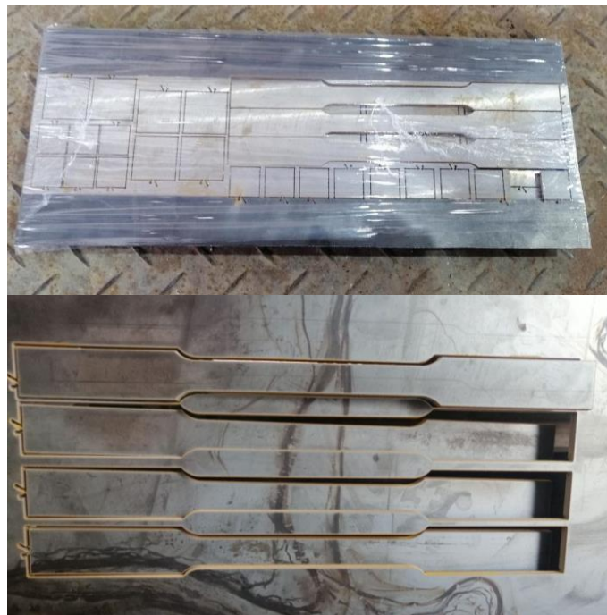
Figura 2.15. Corte de probetas por chorro de agua (Fuente: Propia)
