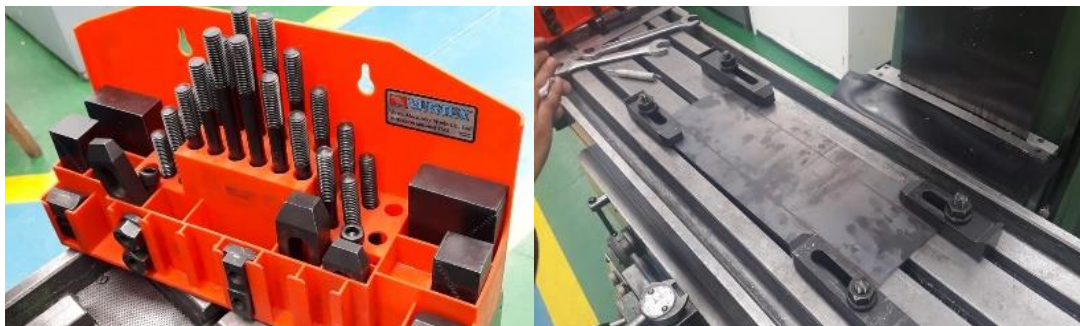
Figura 2.9. Montaje de placas en la fresadora (Fuente: Propia)
