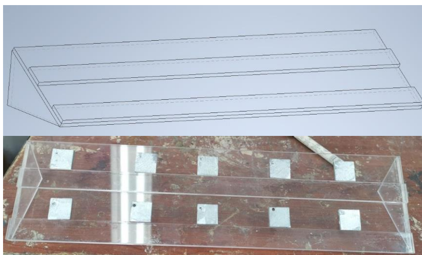
Figura 2.26. Soporte de acrílico colocado dentro de la cámara de corrosión (Fuente: Propia)
