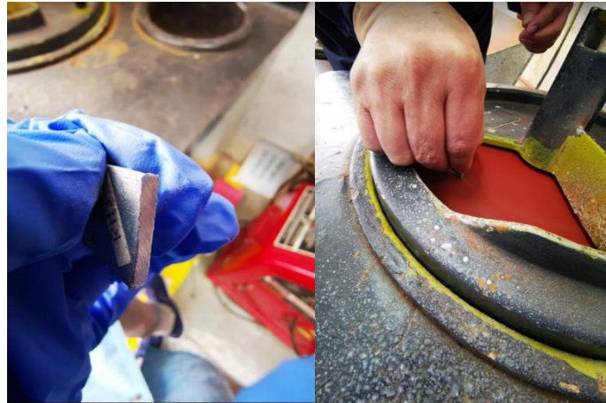
Figura 2.20. Preparación de probetas para micrografía (Fuente: Propia)
