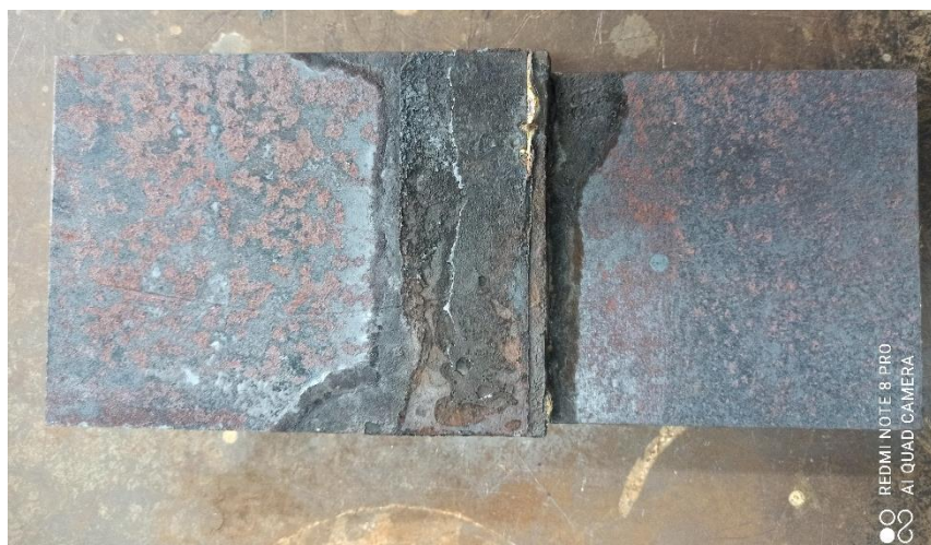
Figura 2.21. Enfriamiento al aire de las placas soldadas
