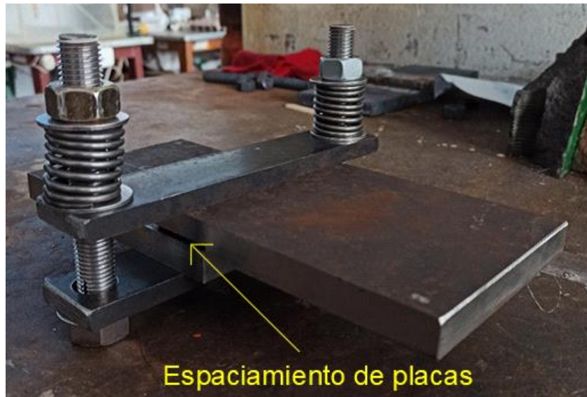
Figura 2.15. Conjunto de placas montadas, matriz, pernos y resortes
