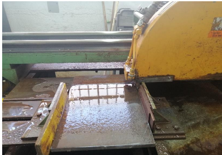
Figura 2.4. Montaje de la plancha de acero ASTM A572
