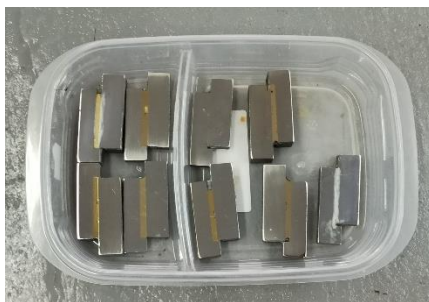
Figura 2.32. Probetas pulidas y colocadas en un recipiente.
