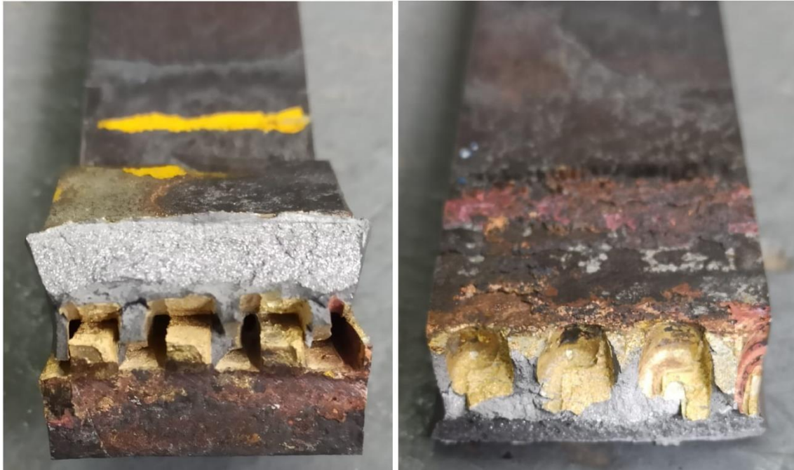
Figura 3.6. Vista frontal de la zona fracturada de la probeta 1P del ensayo de pelado
