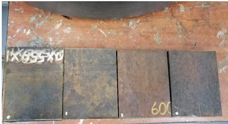
Figura 2.6. Muestras de acero ASTM A572 para el proceso de soldadura.
