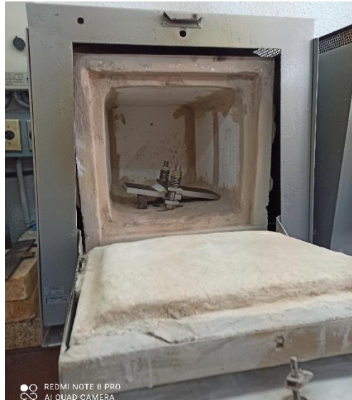
Figura 2.19. Posicionamiento con el cual se ingresará cada una de las placas a soldar
