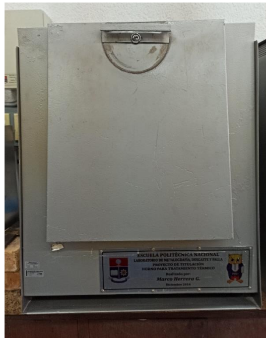
Figura 2.17. Mufla eléctrica del laboratorio de metalografía desgaste y falla
