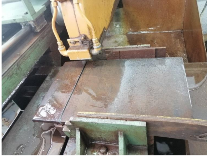
Figura 2.5. Corte de la plancha de acero ASTM A572
