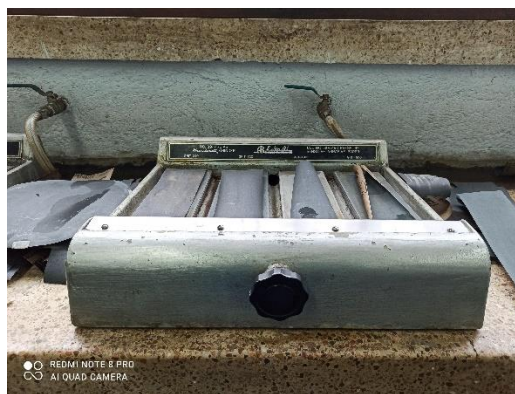
Figura 2.29. Plancha donde se colocan lijas de papel para desbaste fino.
