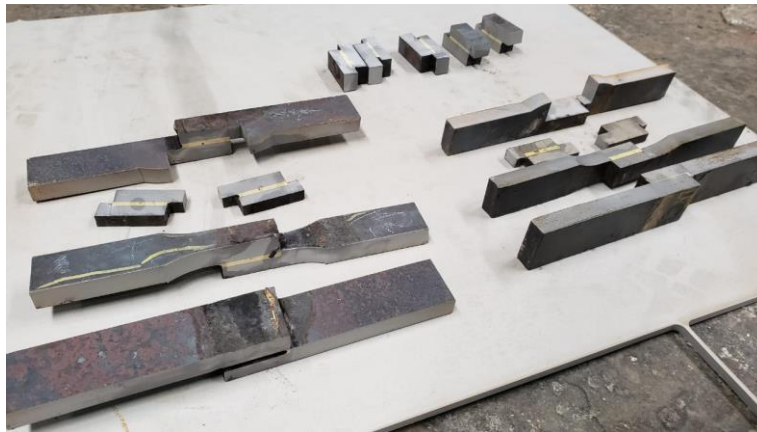
Figura 2.22. Extracción de probetas que fueron cortadas por chorro de agua
