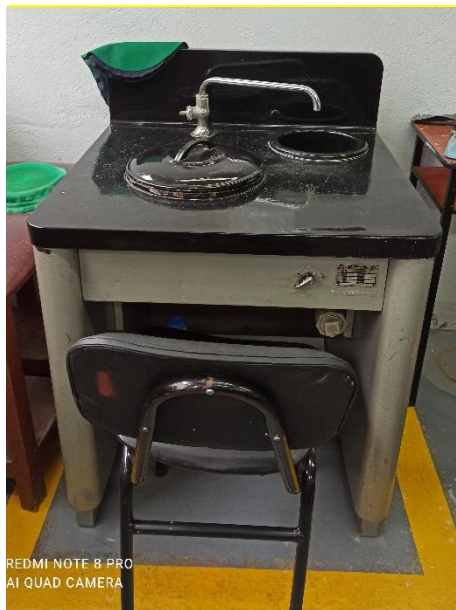
Figura 2.31. Máquina de pulido de probetas Buehler.
