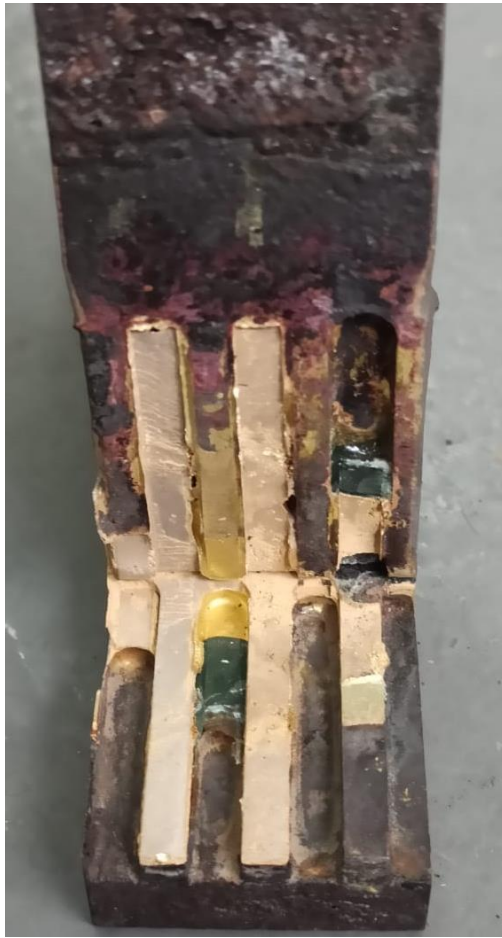
Figura 3.7. Probeta 2P del ensayo de pelado
