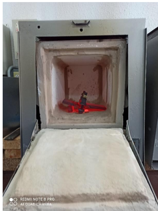
Figura 2.20. Placas después del proceso de soldadura, para el posterior enfriamiento al aire
