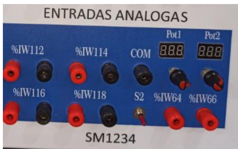
Figura 3.28 Entradas analógicas de la CPU y del módulo SM 1234.
