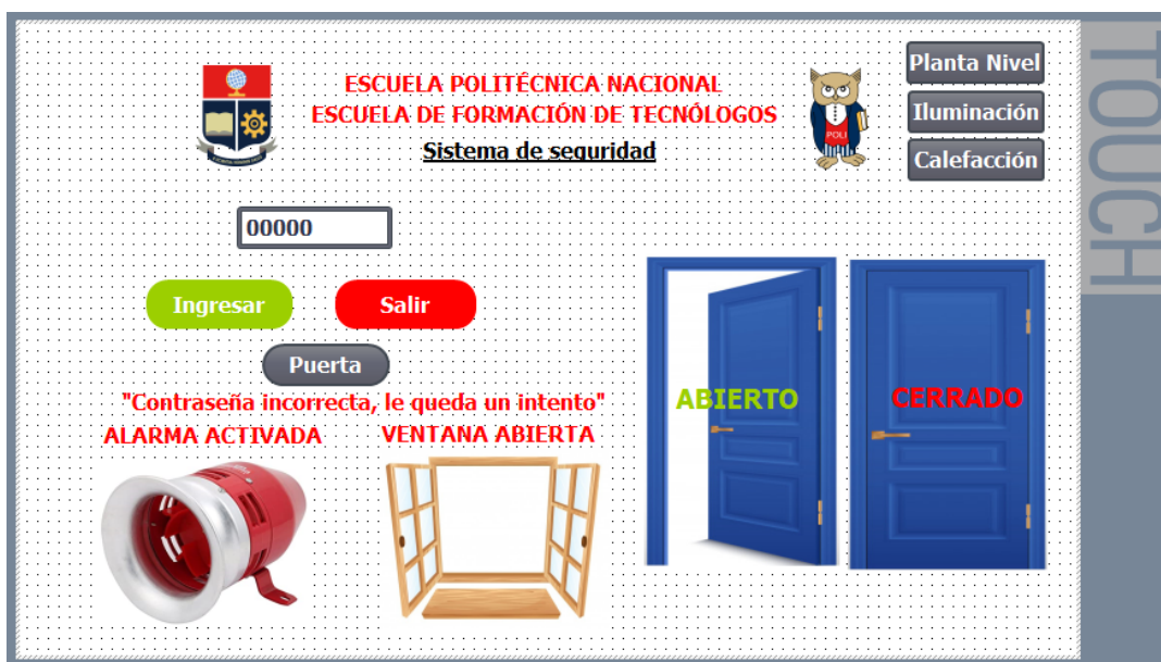
Figura 3.47 Ventana HMI del sistema de seguridad
