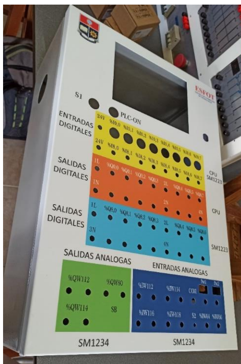
Figura 3.15 Colocación de la etiqueta frontal en las cubiertas.
