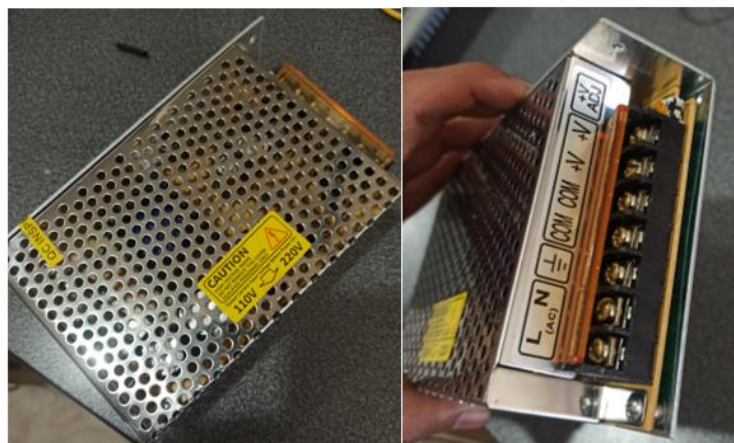
Figura 3.36 Fuente de alimentación 24 (V DC ).
