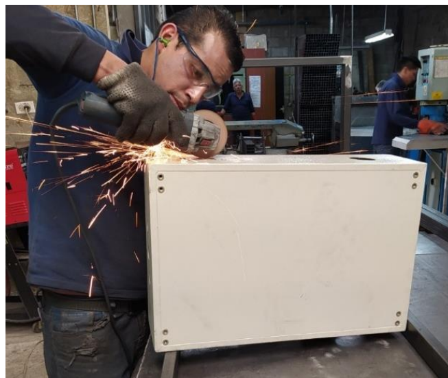
Figura 3.10 Apertura de orificios para puertos de red.
