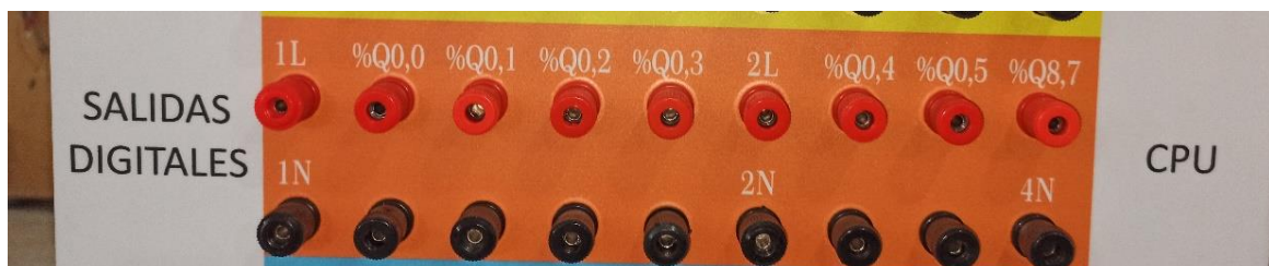
Figura 3.26 Salidas digitales de la CPU 1212C.
