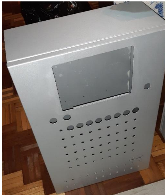
Figura 3.8 Nuevo acabado de los gabinetes.
