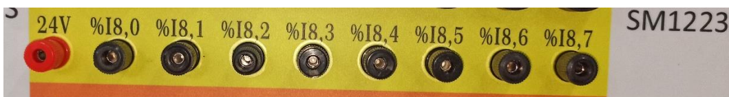
Figura 3.25 Entradas digitales del módulo SM 1223.
