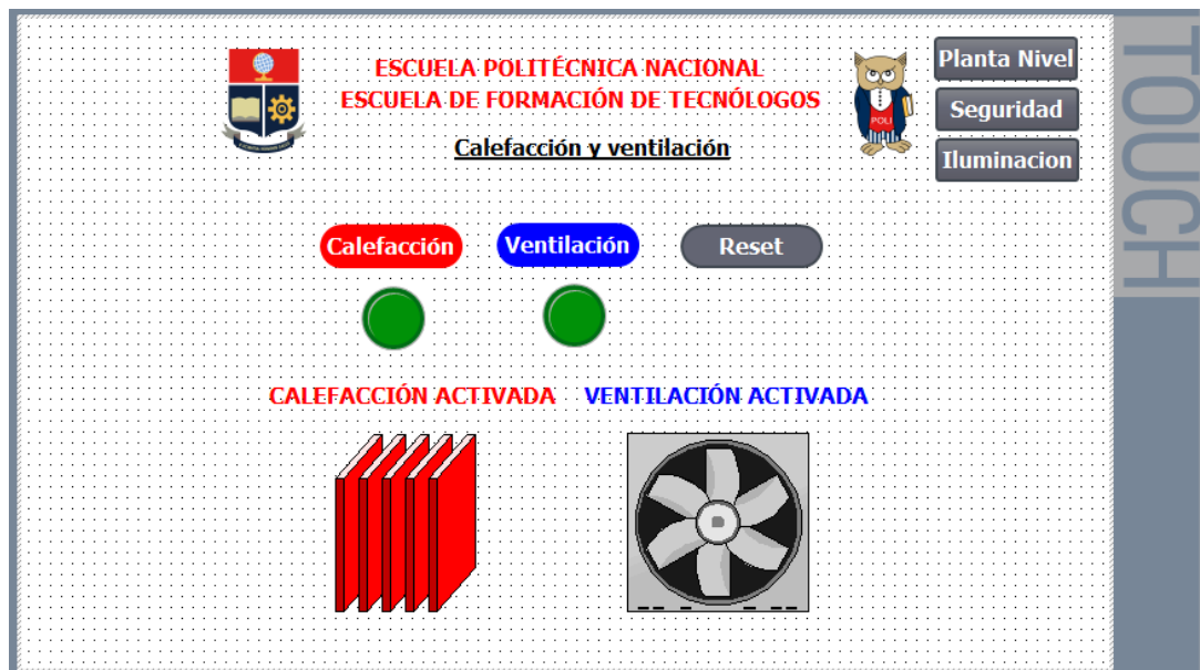
Figura 3.49 Ventana HMI del sistema de calefacción
