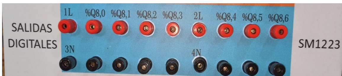
Figura 3.27 Salidas digitales del módulo SM 1223.
