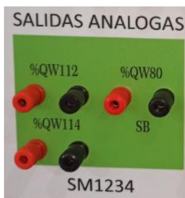
Figura 3.29 Salidas analógicas del módulo SM 1234 y de la Signal Board.
