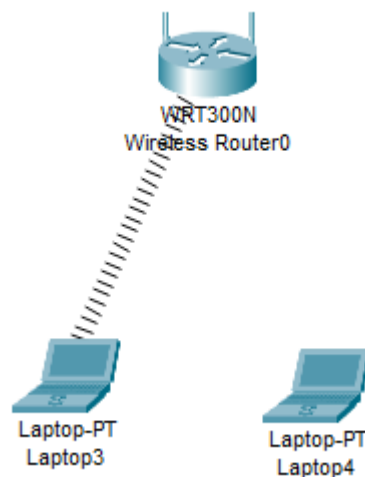
Figura 3.200 Red WLAN con filtro de MAC
