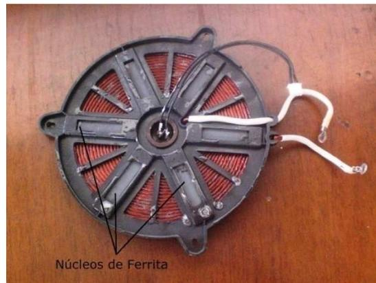
Figura 3.9 Bobina (Vista Inferior) , Fuente propia
