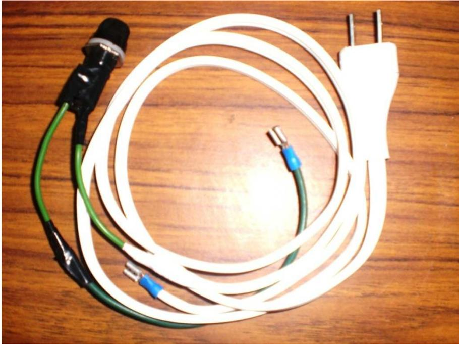
Figura 5.6 Cable de poder y fusible, Fuente Propia
