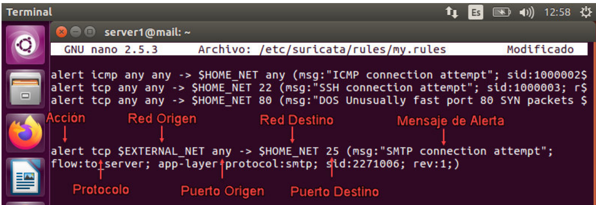
Figura 8.- Estructura general de reglas en Suricata. [Elaboración propia]
