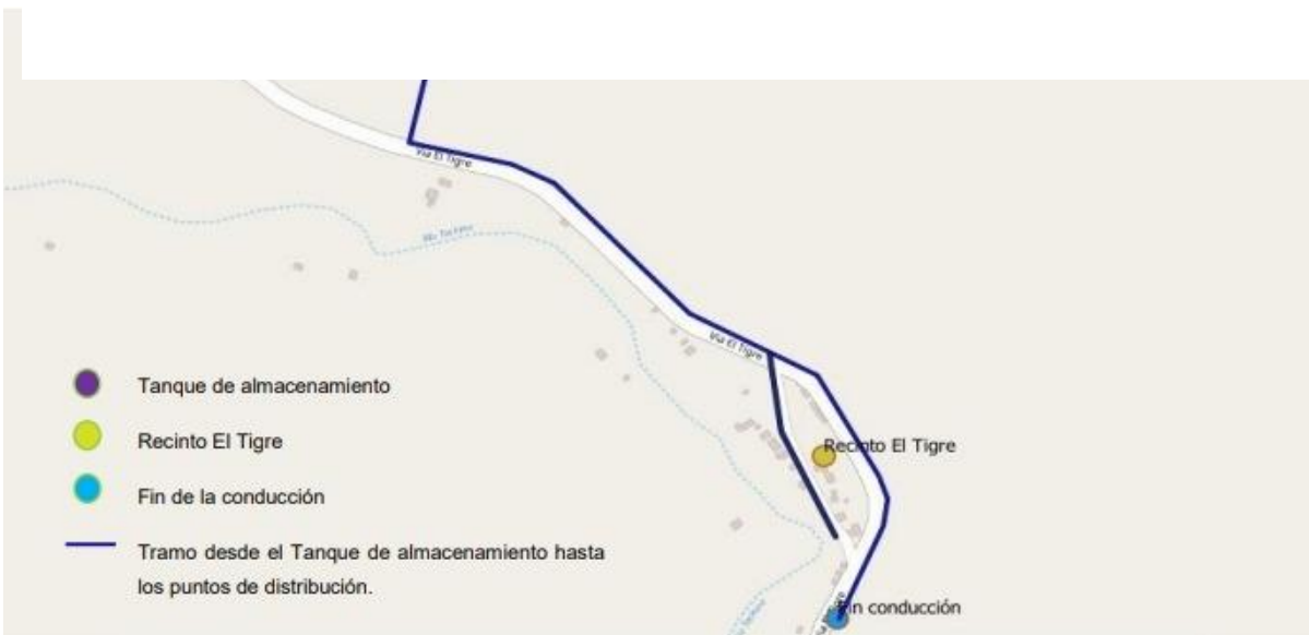
Figura 40. Georreferenciación en QGIS del Tramo de Distribución
