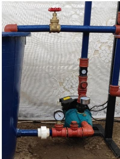
**Figura 3.4** Posición de bomba (succión positiva).
