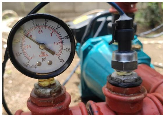
**Figura 3.12** Acoples para manómetro y transductores de presión.
