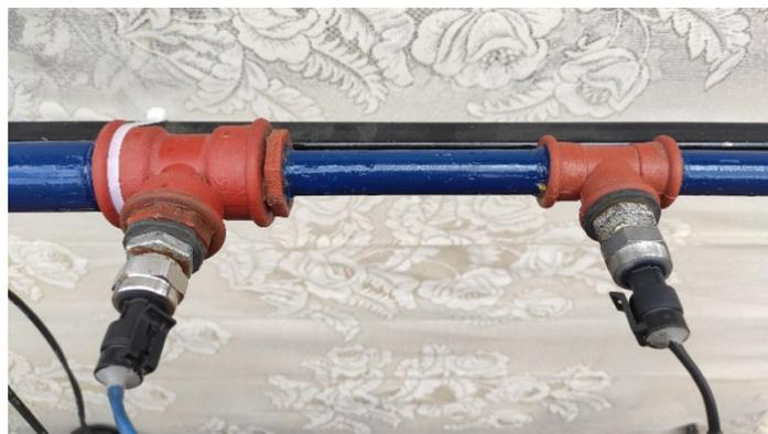
**Figura 3.21** Conexión de transductores de presión en tubo Venturi.
