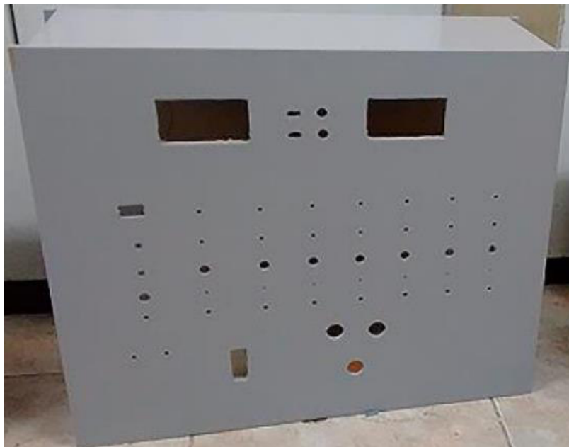
Figura 3.5 Estructura de la mesa ensamblada y pintada.
