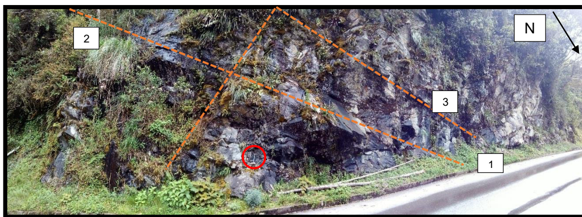
Figura 3.10 Afloramiento de las meta-andesitas, las rocas se encuentran diaclasadas. (Martillo de escala en círculo rojo)
