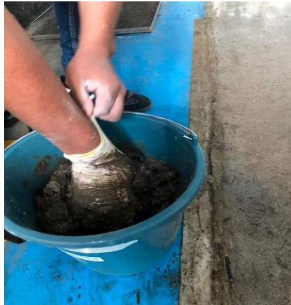
Figura 6. Estabilización con cal viva.
