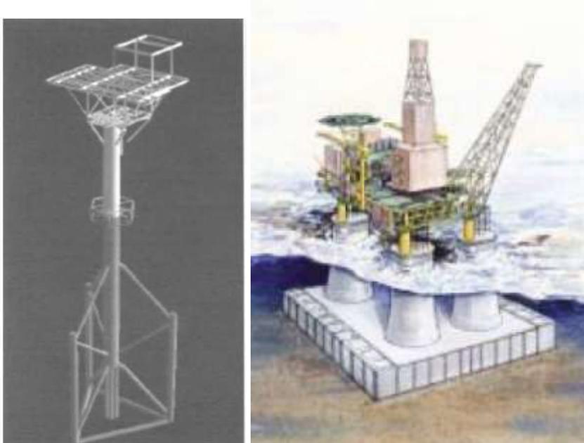
Figura 1.2. Otras estructuras offshore fijas. (a) Plataforma mínima Linx. (b) Plataforma de gravedad
