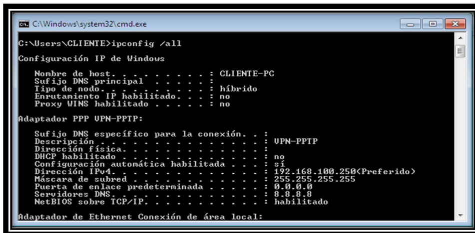
Figura 3.24242 Configuraciones de la máquina para los adaptadores de red, ingresando a CMD Se puede observar que ha sido asignada de manera automática la dirección IP 192.168.100.250.
