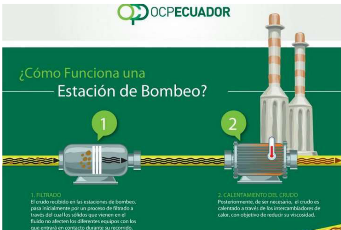
Figura 5.1 Procedimiento de calentamiento de crudo en las estaciones de bombeo del OCP.
