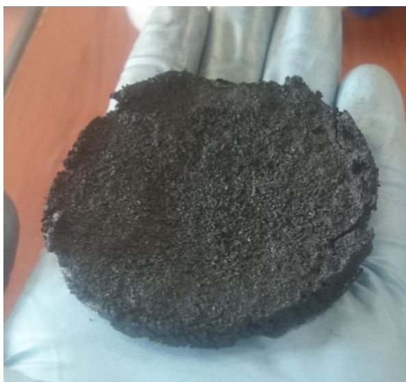
Figura 2.3: Grafeno filtrado y lavado.
