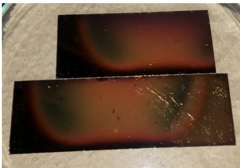
Figura 2.6: Láminas de mica con oro depositado
