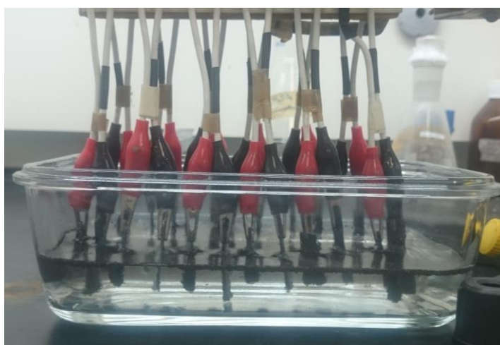
Figura 2.1: Esquema para la exfoliación electroquímica.
