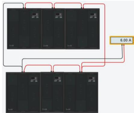
**Figura 3.10** Conexiones banco de baterías.
