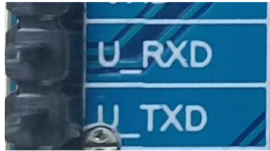
Figura 3.9 Pines de transmisión y recepción del módulo A7
