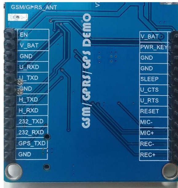
Figura 3.4 Distribución de pines en módulo A7
