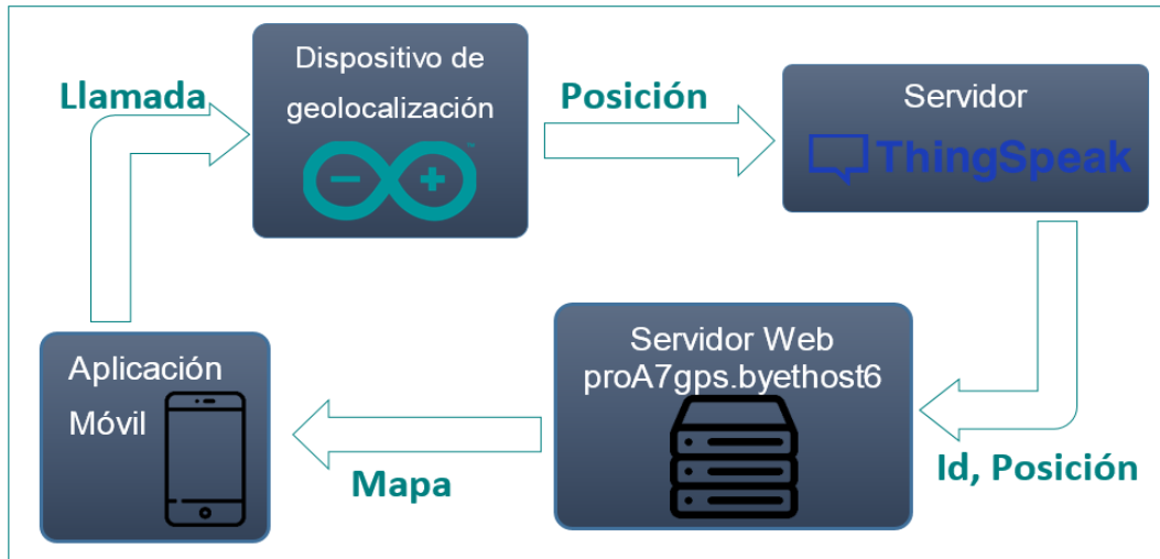
Figura 3.47 Descripción de todo el sistema del prototipo de geolocalización
