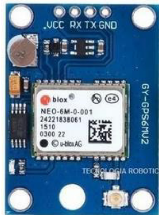
Figura 3.6 Módulo Neo6m con componentes [34]
