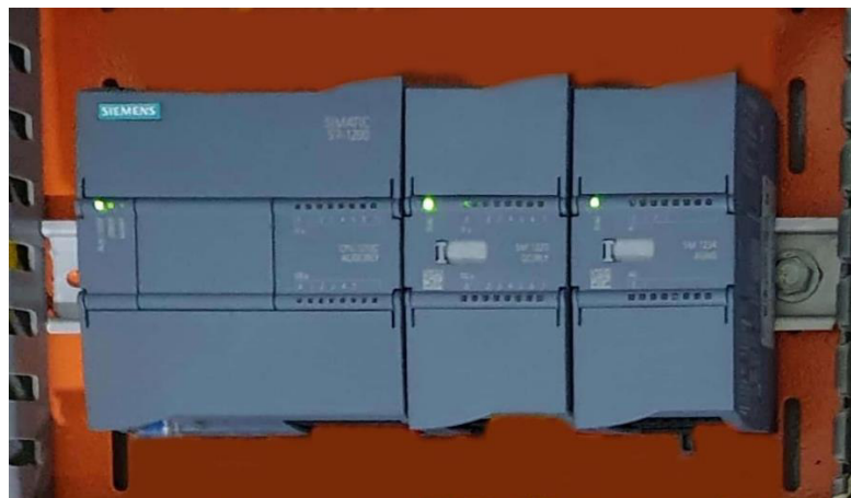
Figura 3.20 Módulos de expansión acoplados con el PLC S7-1200.
