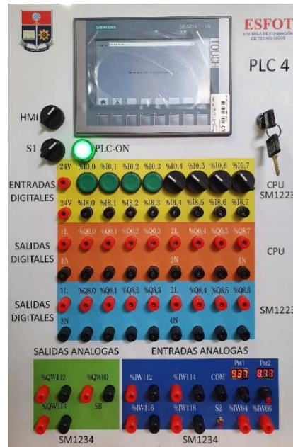
Figura 3.34 Módulo didáctico 04 terminado (vista frontal).
