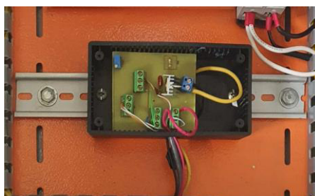
Figura 3.2 Circuito de acondicionamiento para las entradas análogas
