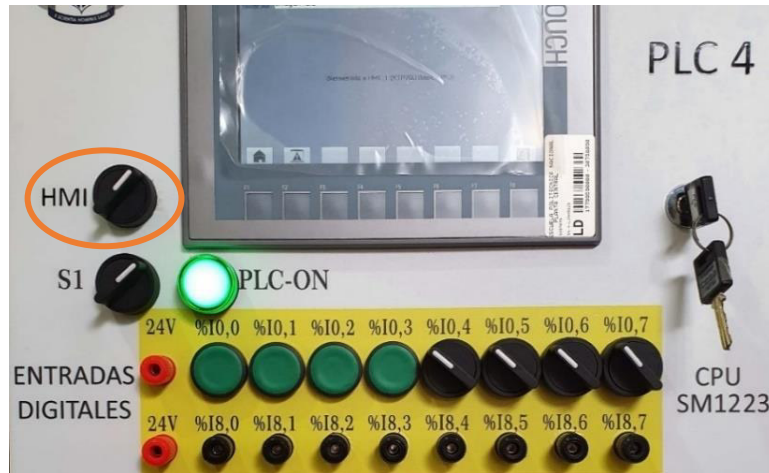
Figura 3.30 Pantalla instalada en el módulo didáctico.
