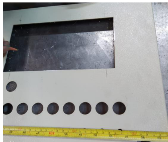
Figura 3.10 Toma de medidas para la realización de cortes.
