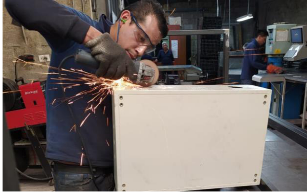
Figura 3.11 Cortes laterales para los módulos.
