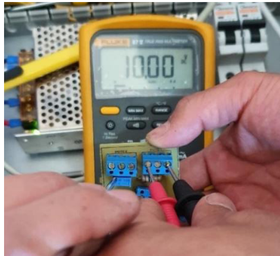
Figura 3.49 Verificación del voltaje del circuito de acondicionamiento.
