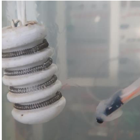
Figura 3.53 Niquelina y sensor LM35.
