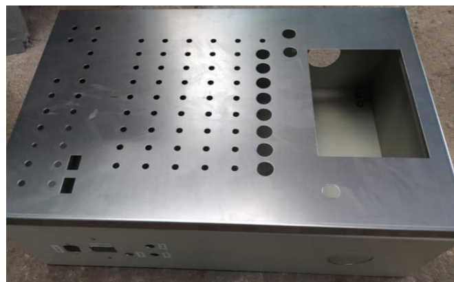
Figura 3.13 Reensamblaje de la cubierta en el módulo.
