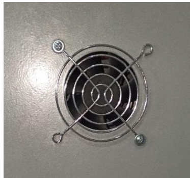
Figura 3.14 Ventilador instalado en uno los módulos.
