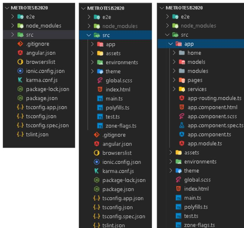
**Fig. 8.** Estructura del Proyecto Aplicación Móvil
