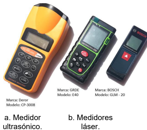
Figura 3.4 Modelos de medidores empleados en arquitectura e ingeniería civil.
