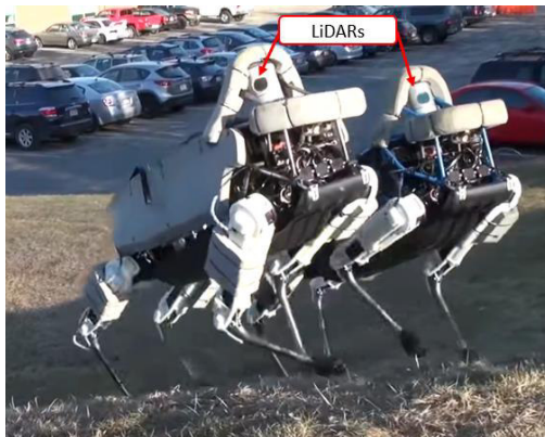
a. Robots Spot Classic de Boston Dynamics empleando sistemas LiDAR [9].
