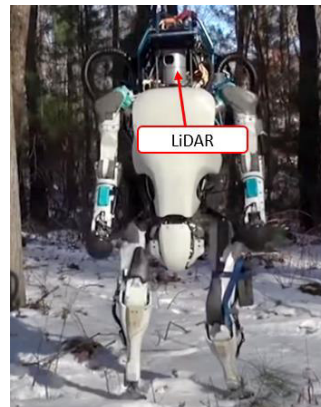
b. Robot Atlas de Boston Dynamics empleando un sistema LiDAR [10].
