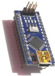
Figura A.1 Microcontrolador ATmega328 embebido en la placa Arduino Nano.
