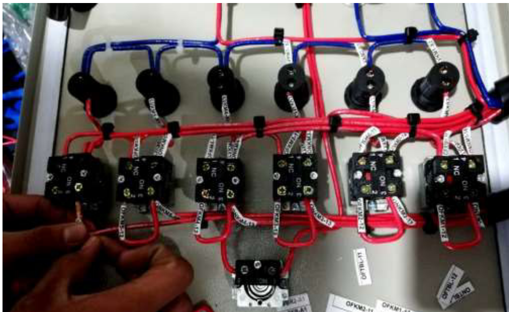
Figura 3.20 Etiquetado del circuito de fuerza.
