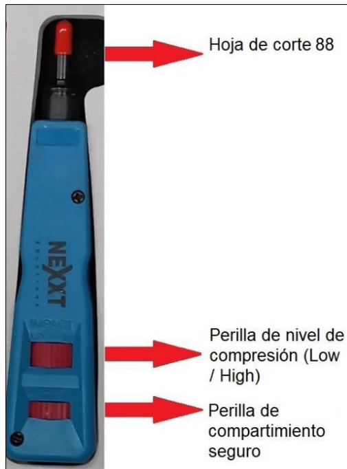
Figura 3.3 Partes de la herramienta de impacto (88/110)
