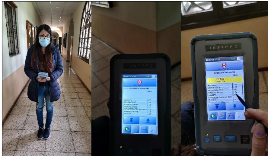
Figura 3.32 Detección de redes inalámbricas con nivel de RSSI
