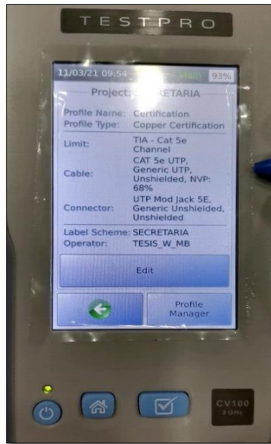
Figura 3.11 Configuración de parámetros para certificación de canal
