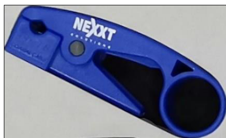
Figura 3.5 Desforradora de cables UTP/STP
