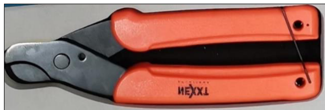
Figura 3.6 Cortadora de cables UTP/STP
