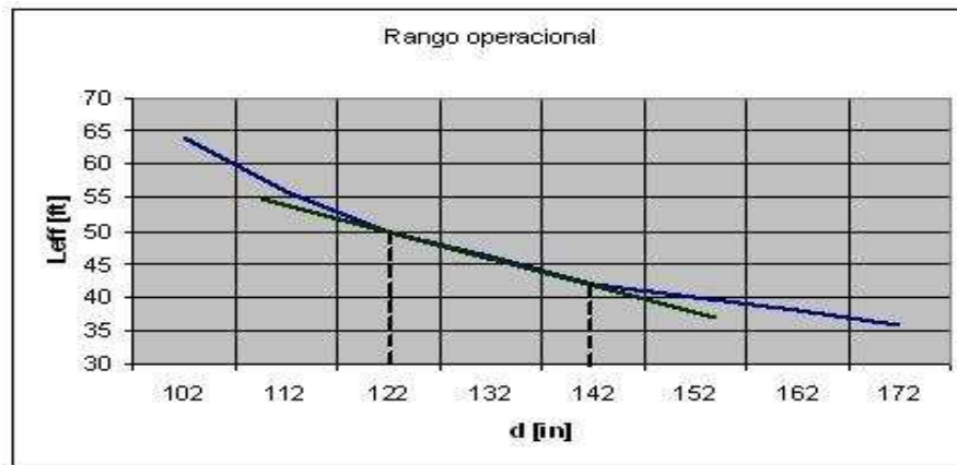
Figura 3.12 Diámetro del separador vs. Longitud del separador, diseñado bajo norma API 12J
