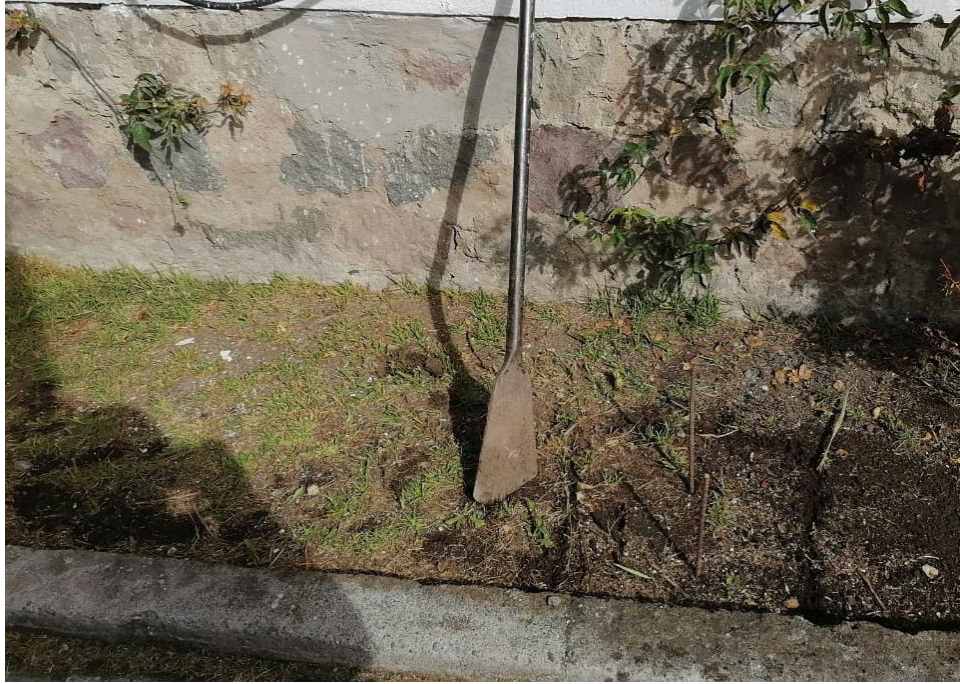
Figura 1.5 Ubicación del electrodo C_1 para medición de resistividad.
