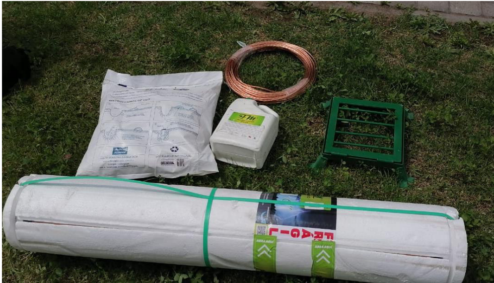
Figura 3.5 Materiales para implementación de la puesta a tierra.
