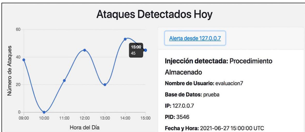
Figura 61. Resultado Inyección de código SQL Procedimiento Almacenado en pestaña de Ataques
