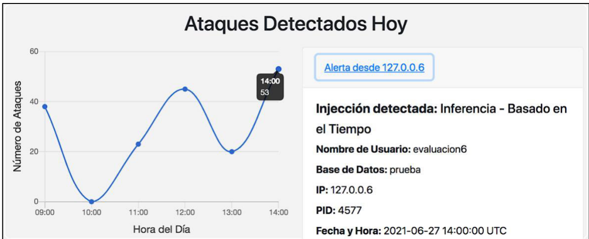
Figura 59. Resultado Inyección de código SQL Inferencia – Basada en Tiempo en pestaña de Ataques
