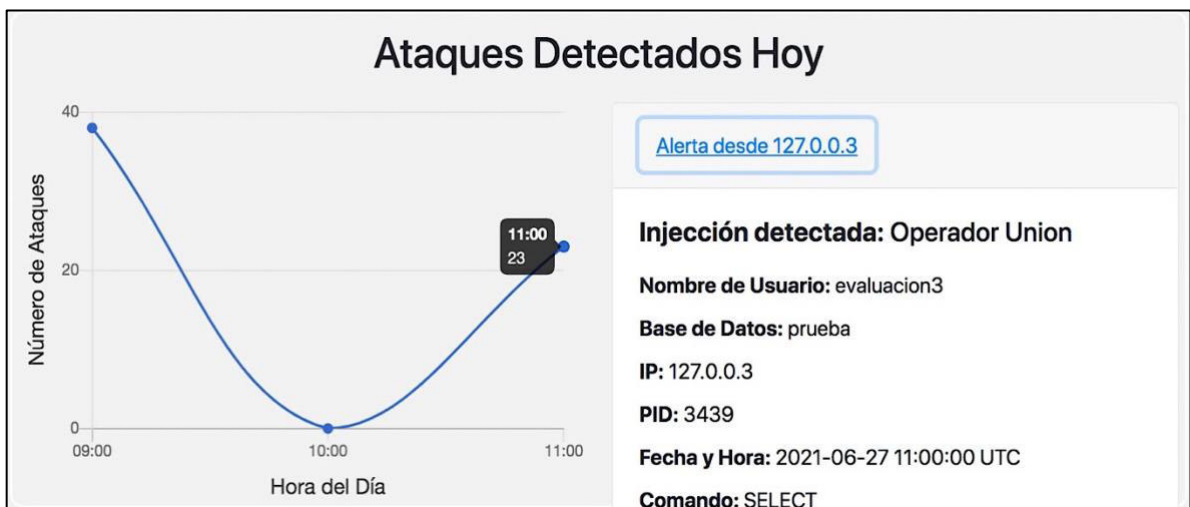
Figura 53. Resultado Inyección de código Operador Unión en pestaña de Ataques
