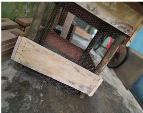
**Figura 14.** Colocación de malla con clavos
