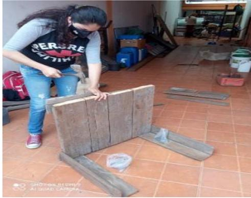
**Figura 13.** Unión de los pedazos cortados con clavos
