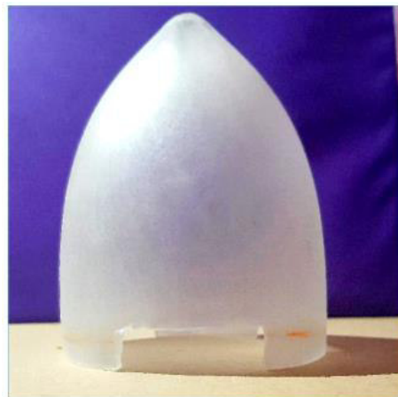
Figura 3.26 Nariz del módulo aerogenerador.
