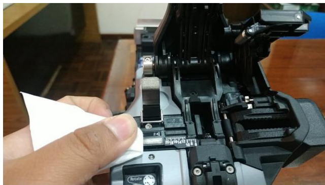
Figura A2.96 Limpieza del canal de colocación de la fibra
