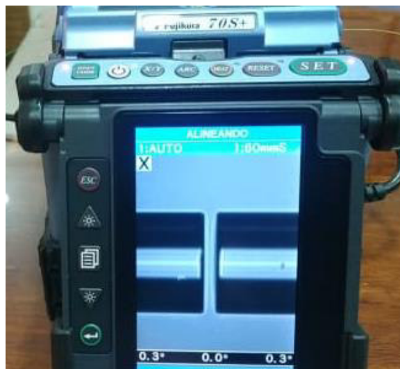
Figura A2.52 Calibración de Arco (alineado de fibras)
