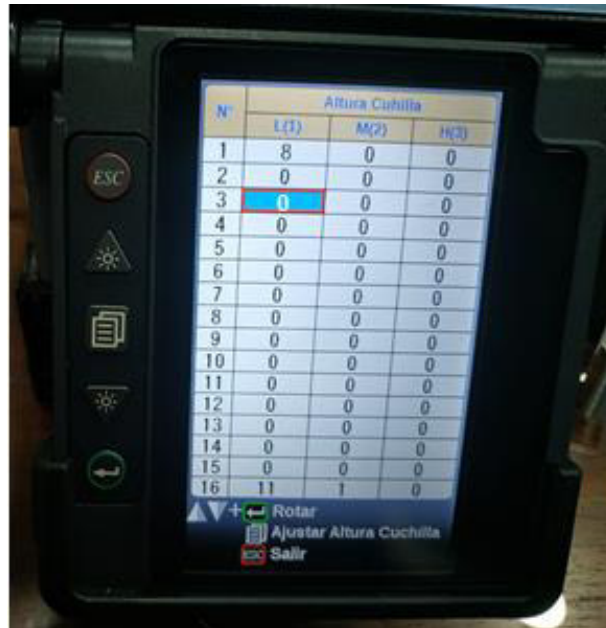
Figura A2.36 Cambio de la posición de la cuchilla visto desde la fusionadora
