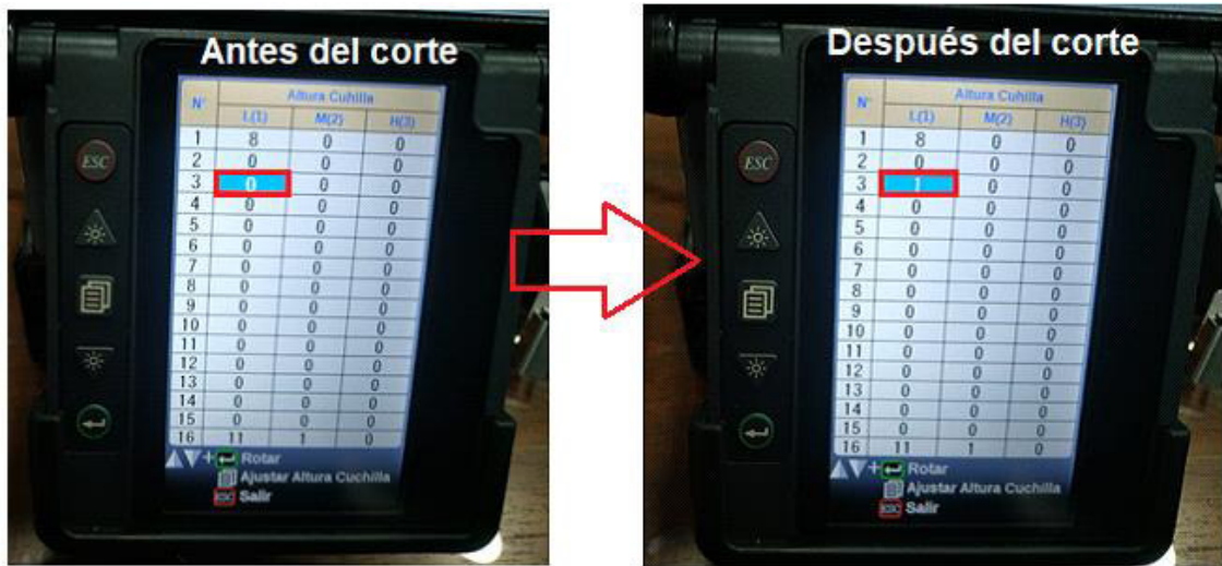
Figura A2.40 Registro del corte en la fusionadora
