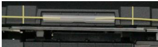
Figura A2.65 Colocación del tubillo de fusión en la parte fusionada.
