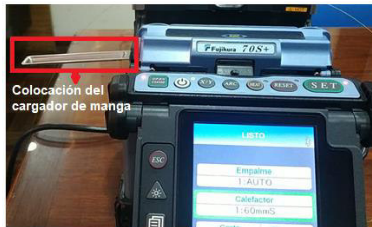
Figura A2.59 Colocación del cargador de mangas en la fusionadora
