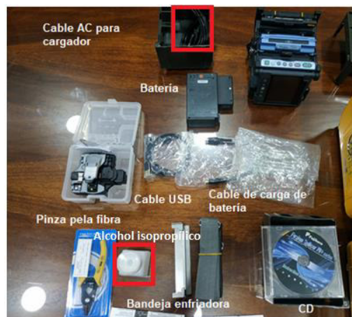
Figura A2.6 Equipamiento de la fusionadora Fujikura 70S+
