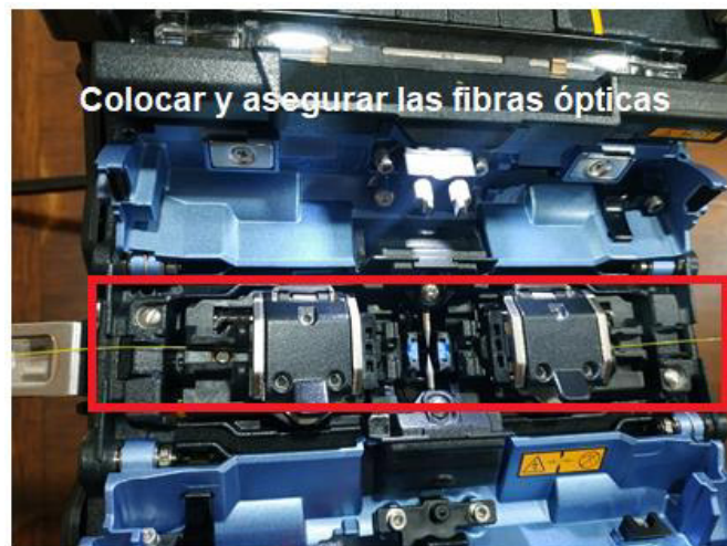
Figura A2.63 Colocación y fijación de la fibra óptica
