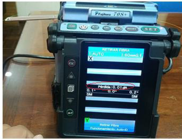
Figura A2.64 Resultados de la fusión de la fibra óptica
