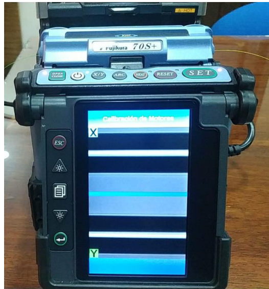
Figura A2.51 Finalización de la Calibración de Motores
