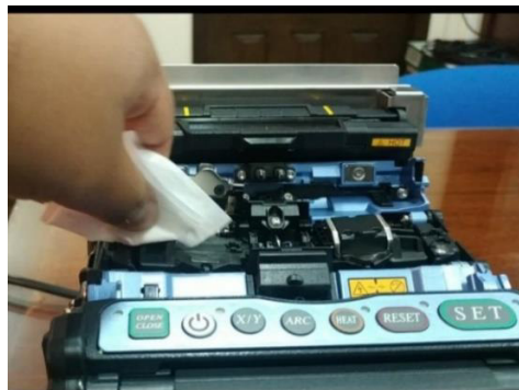
Figura A2.93 Limpieza de la superficie donde se asienta la fibra
