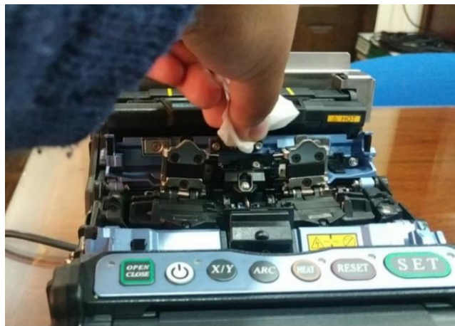
Figura A2.91 Limpieza de las placas de la abrazadera de fibra
