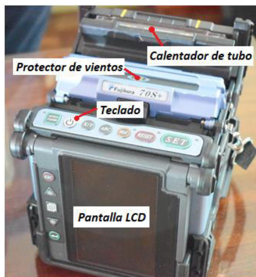
Figura 1.2 Partes frontales y superiores de la fusionadora Fujikura 70S+
