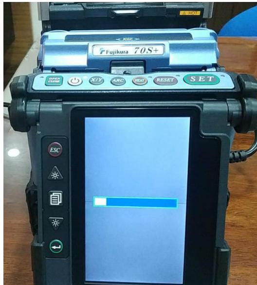
Figura A2.46 Ejecución de la Prueba de Suciedad
