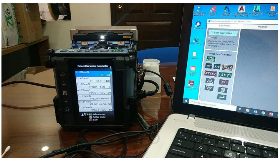
Figura 3.11 Comunicación entre la computadora y fusionadora
