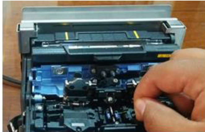
Figura A2.90 Eliminación del exceso de fibras en las ranuras en V
