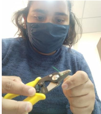
Figura A2.3 Eliminación de la cubierta y revestimiento de la fibra óptica
