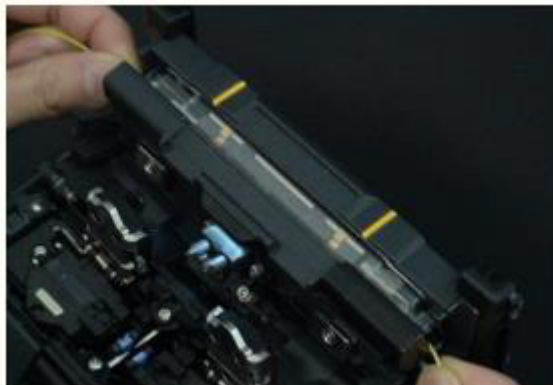
Figura A2.66 Colocación de la fibra óptica en el horno
